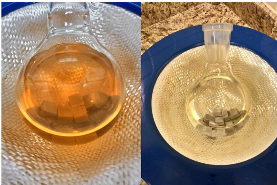
**Figura 15 – Seis amostras nos balões com fluido de corte, à esquerda, e seis amostras no balão com água, à direita. Fonte: Autorial própria.**
