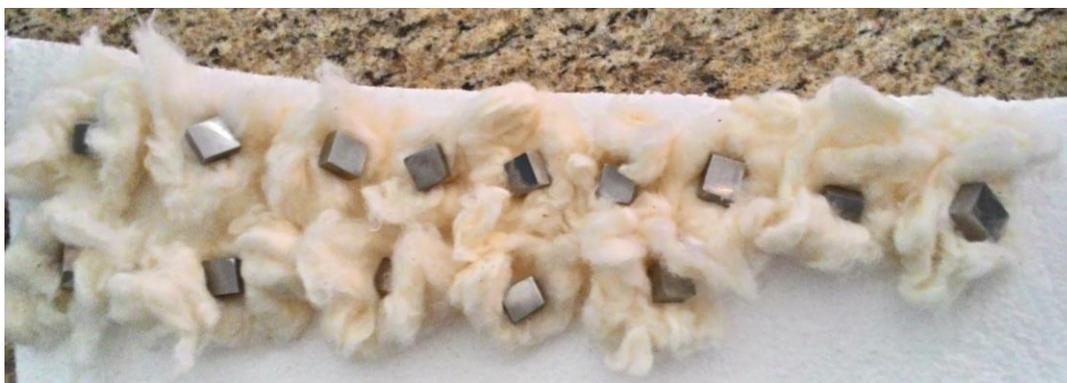
Figura 13 - Amostras polidas e prontas para serem inseridas no sistema corrosivo. Fonte: Autorial própria.
