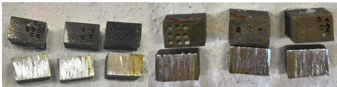
**Figura 18 - Amostras serradas em seção transversal após período de corrosão. Fonte: Autoria própria.**
