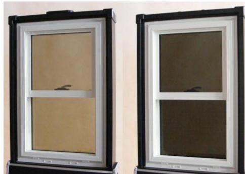
Figura 2 - Efeito termocrômico em janela Fonte – ZONGTAO, GAO, & CHEN (2011).
