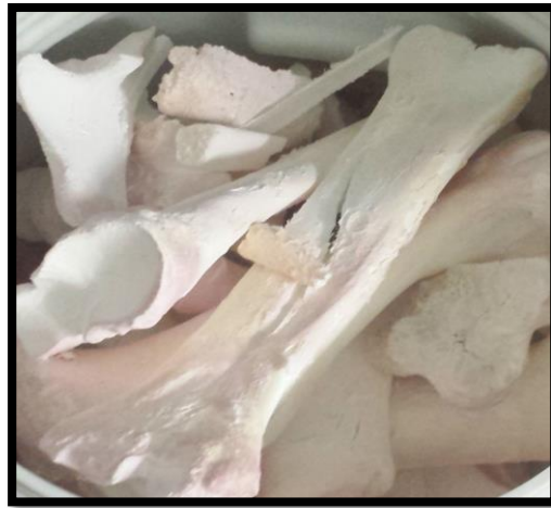
Figura 3 – Osso bovino calcinado a 1000°C. Fonte: Autorial própria
