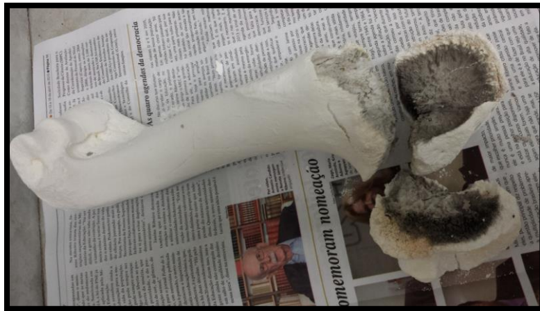
Figura 2 – Osso bovino calcinado a 700°C. Fonte: Autoria própria.
