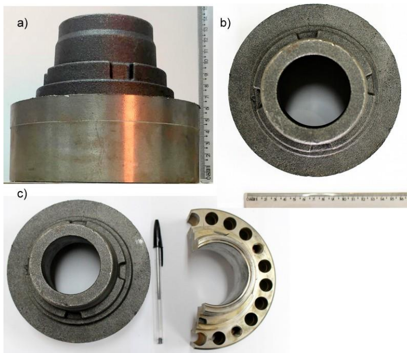
Figura 16 — Peça semi-usinada: (a) vista frontal; (b) vista superior; (c) vista superior da peça semi-usinada e peça já usinada cortada ao meio à direita.
