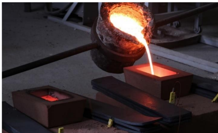
Figura 7 — Vazamento do metal líquido no molde.
