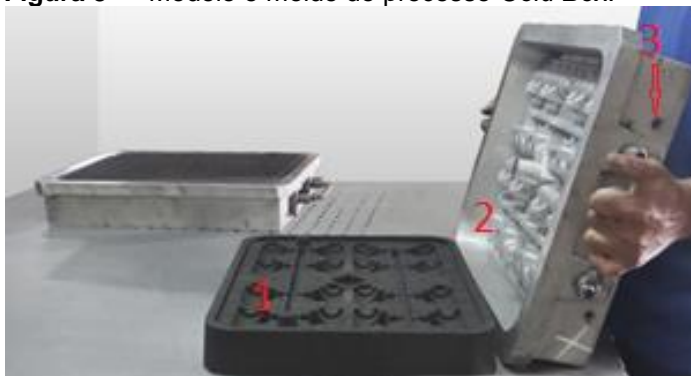
Figura 8 — Modelo e molde do processo Cold Box .
