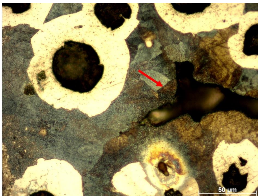
Figura 24 — Microestrutura da amostra 2. Aumento 500x. Ataque Nital.
