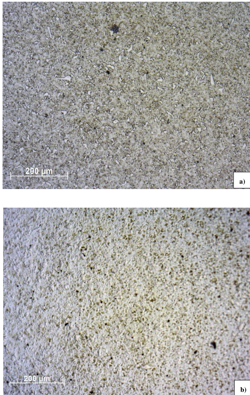
Figura 22 - Micrografia do aço AISI D6 após o revenimento duplo a 200 °C por duas horas cada da amostra a) temperada a 950 °C e b) temperada a 1050 °C por 50 minutos e resfriadas em óleo. Ataque com Nital 2%. Aumento de 100x.
