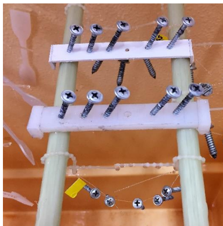
Figura 9 – Suportes com abas para melhor estabilidade.
