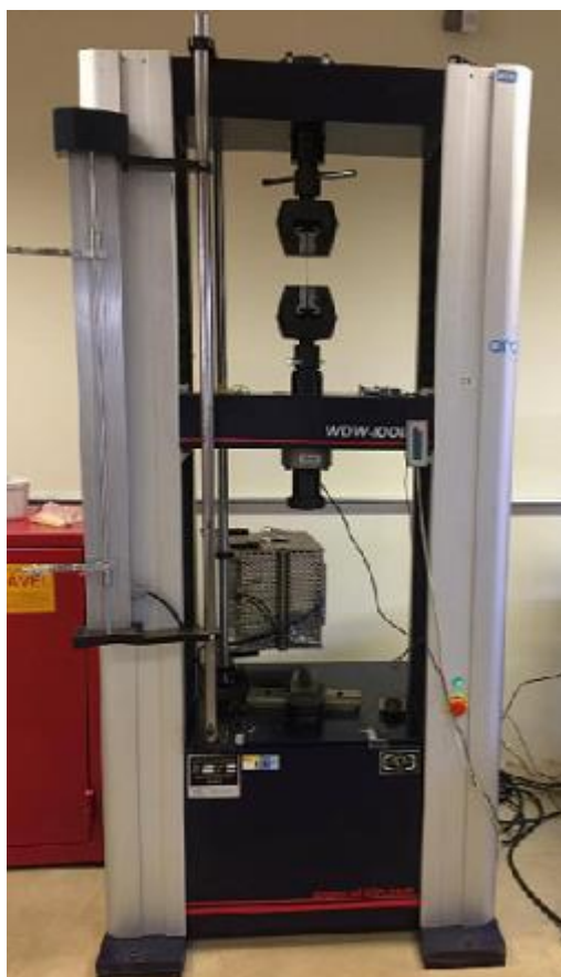
Figura 15 – Máquina de tração Shijin modelo WDW-100E situada no lab. Da UTFPR, campus Londrina.
