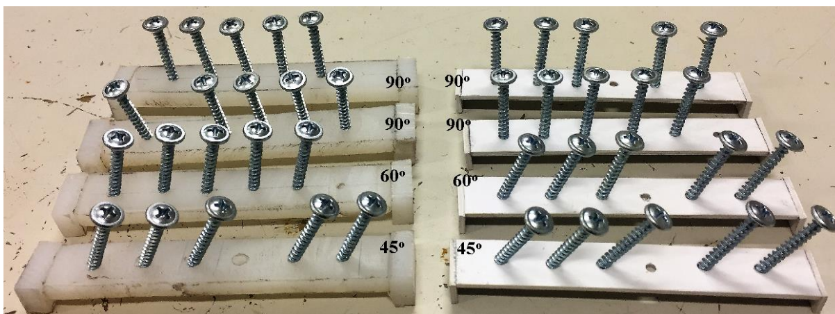
Figura 10 - Amostras posicionadas nos suportes de PA (esq.) e PVC (dir.) com diferentes angulações
