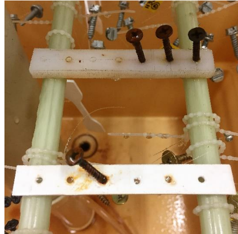
Figura 8 – Primeiros suportes desenvolvidos de PA (ao fundo) e PVC.
