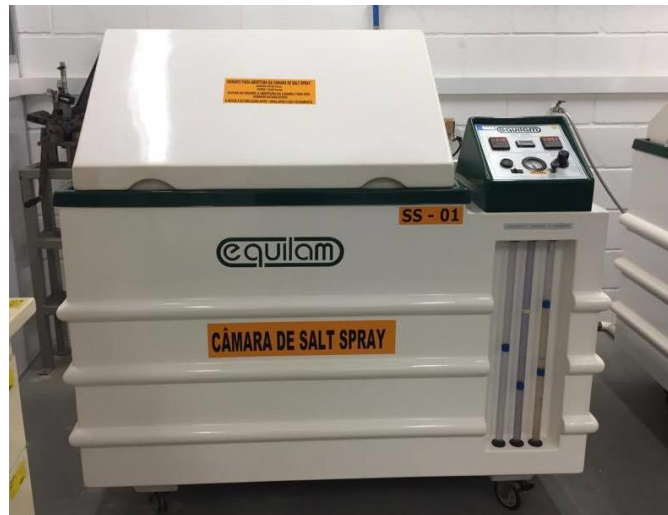
Figura 1 – Câmara de Névoa Salina disposta no Laboratório da empresa Ciser Parafusos e Porcas.
