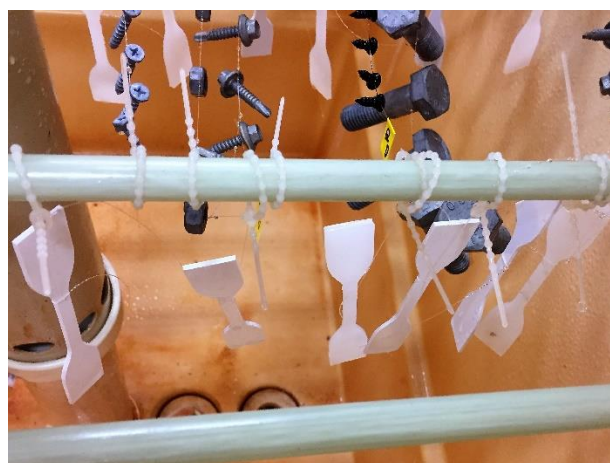
Figura 14 – CPs dispostos em câmara de névoa salina.
