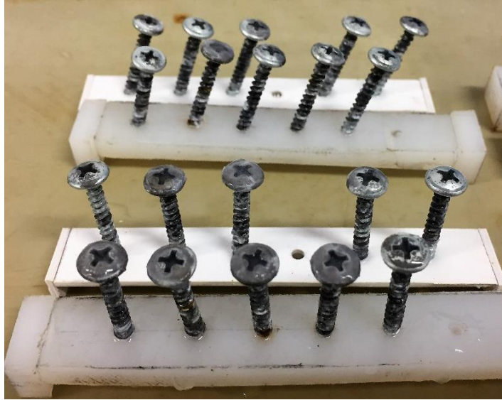
Figura 17 – Acúmulo de solução nas “cabeças” dos parafusos com angulação de 90° (à frente), dispostos à esquerda na parte frontal da câmara.
