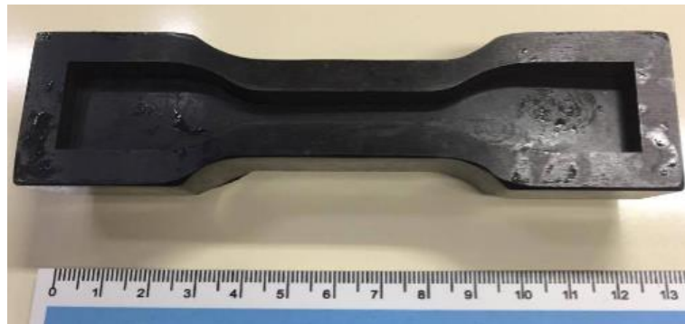
Figura 13 – Molde para confecção de corpos de prova nas especificações da norma ASTM D638-08.
