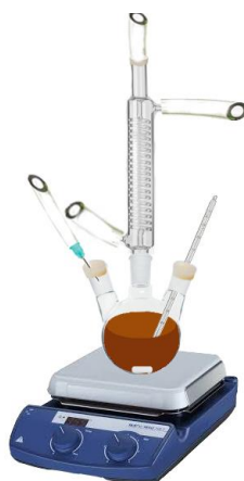
Figura 13 - Esquema do processo de síntese de pontos quânticos coloidais.
