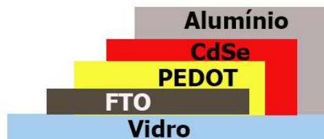
Figura 6 - Ilustração do Dispositivo Fotovoltaico em camadas.
