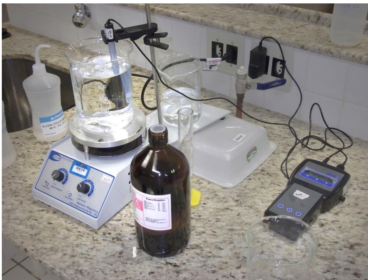
Figura 8 - Aparato organizado para produção da solução de suor artificial e medição do pH. Na imagem é possível observar o agitador magnético a esquerda e o pHmetro a direita, com sua ponteira de leitura posicionada dentro do béquer no qual se encontra a amostra.
