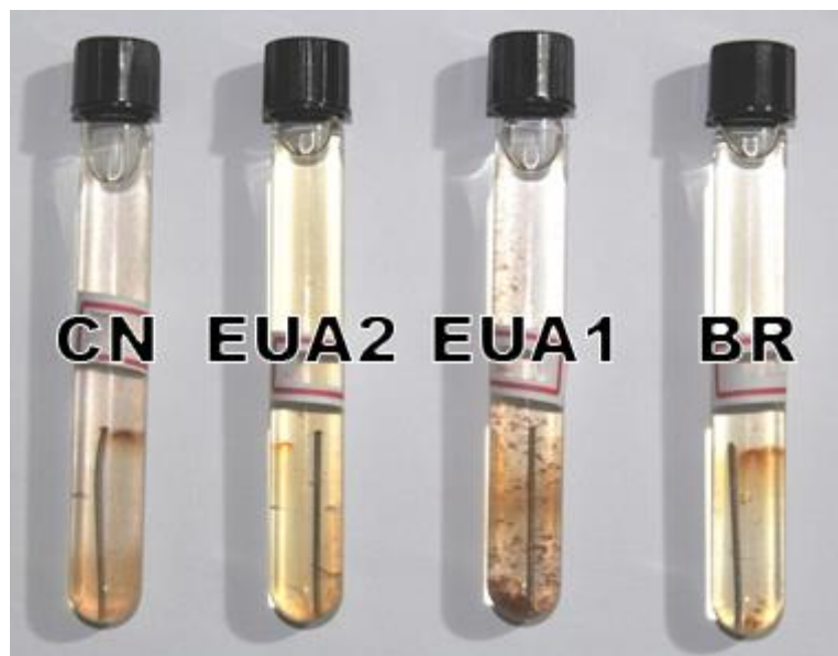
Figura 24 - Amostras imergidas em solução de suor artificial em tubos de ensaio.
