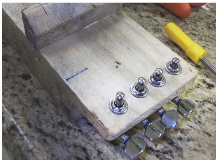
Figura 10 - Tarraxas instaladas e fixadas no aparato. Fonte: Autoria própria.
