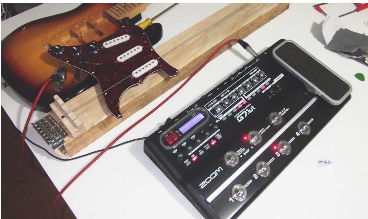
Figura 12 - Teste da configuração utilizada para o ajuste da frequência de vibração das cordas. Fonte: Autoria própria.
