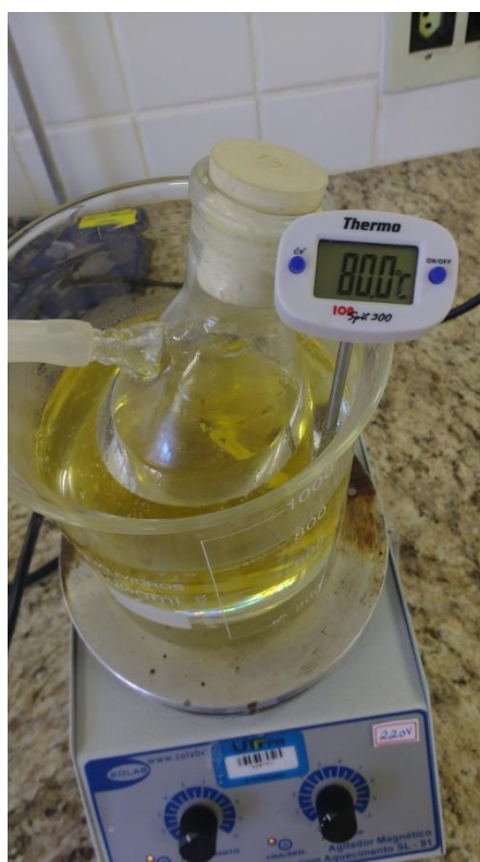
Figura 14: controle de temperatura do óleo de mamona submetido à secagem.
