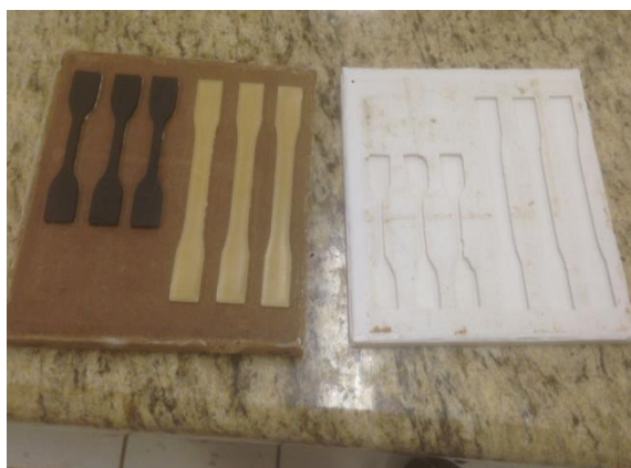
Figura 16: Molde de corpos de prova de tração, em silicone, após desmoldagem da caixa de madeira.
