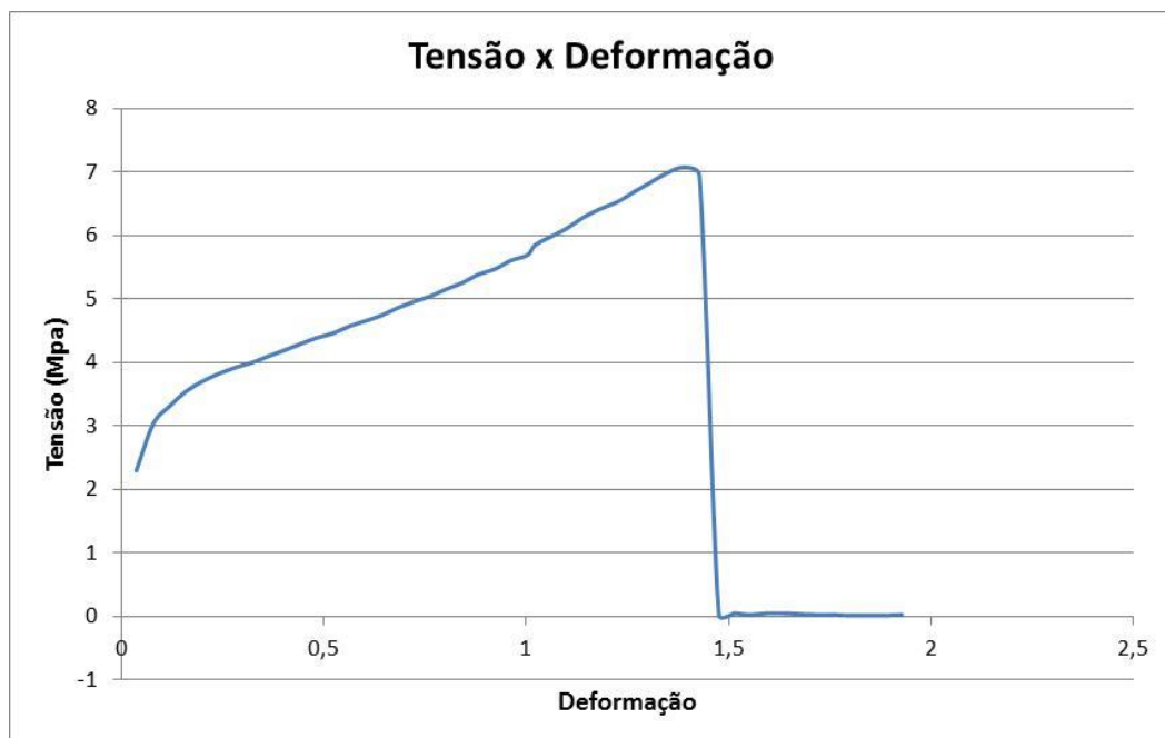
Figura 29: Gráfico tensão x deformação para corpos de prova tipo IV a 500 mm/min.
