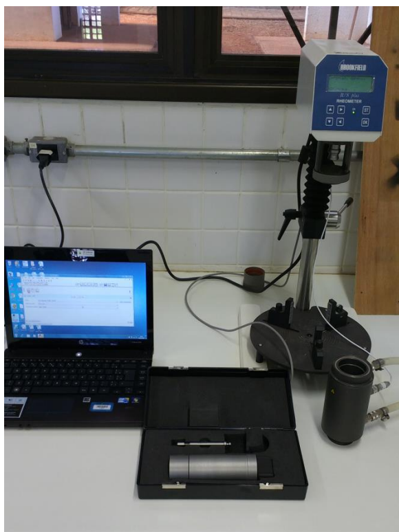
Figura 12: Rêometro Brookfield R/S plus (RS4+SST) disponível no câmpus da UTFPR Londrina.
