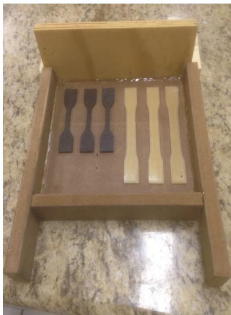
Figura 15: Arranjo de modelo de corpos de prova em caixa de madeira, para confecção de molde em silicone.
