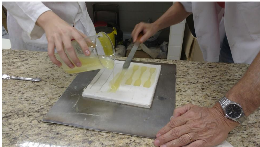
Figura 17: Moldagem por casting dos corpos de prova de tração.
