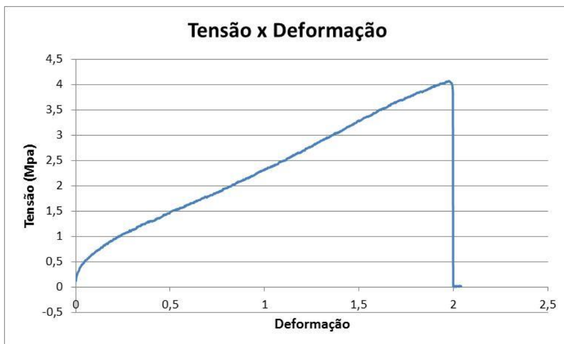
Figura 31: Curva tensão x deformação para o corpo de prova do tipo I ensaiado à velocidade de 50 mm/min.
