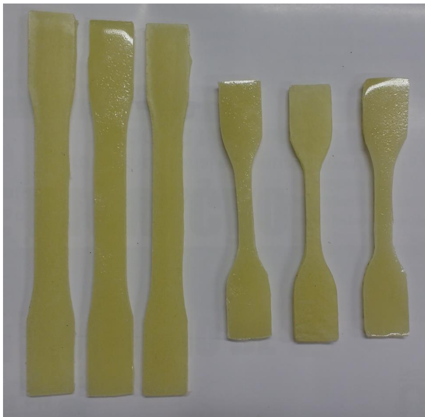
Figura 19: Corpos de prova do elastômero final, obtido a partir do pré-polímero de uretana produzido.
