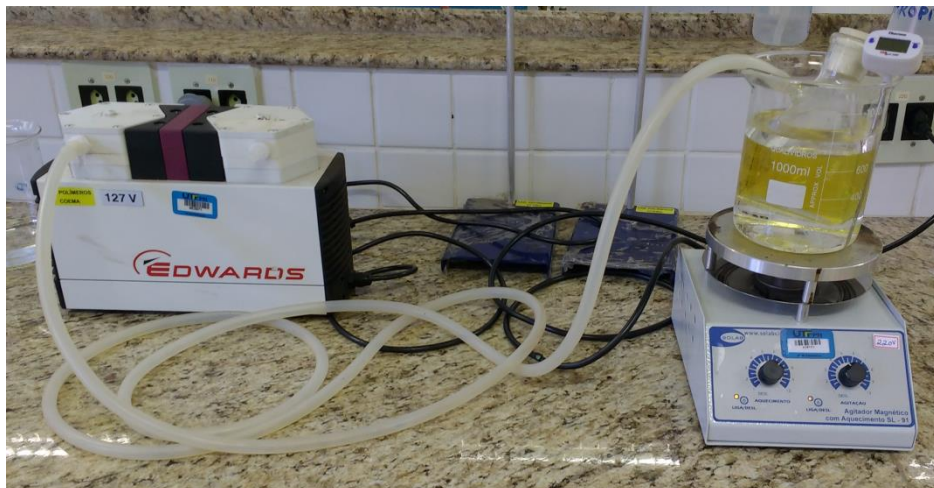
Figura 13: Sistema para secagem do óleo de mamona através da utilização de uma bomba de vácuo e uma manta de aquecimento.
