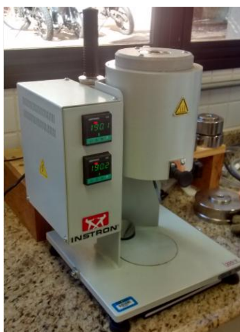
Figura 11: Ceast MF10 – Ensaio de fluidez
