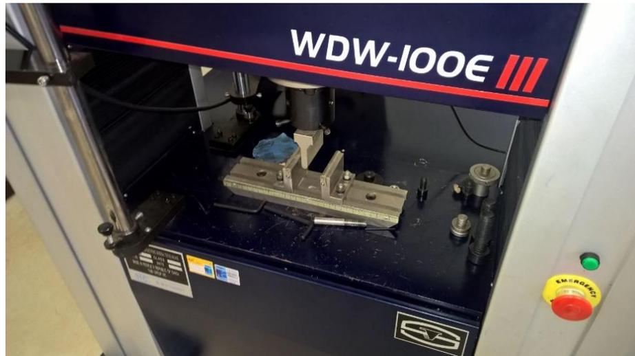
**Figura 7 – Base para ensaio de Flexão de 3 pontos instalada na máquina de ensaio universal (WDW – 100E)**
