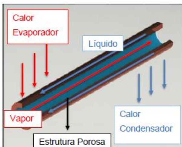
**Figura 1 - Funcionamento de um tubo de calor**
