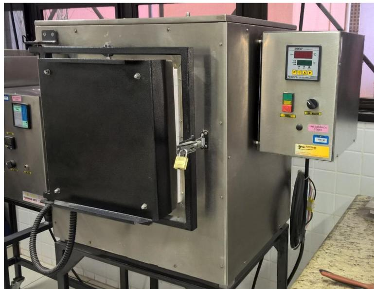
Figura 6 – Forno com capacidade para 1250°C (Modelo FCN)
