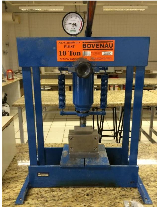
Figura 5 – Prensa hidráulica capacidade 10t
