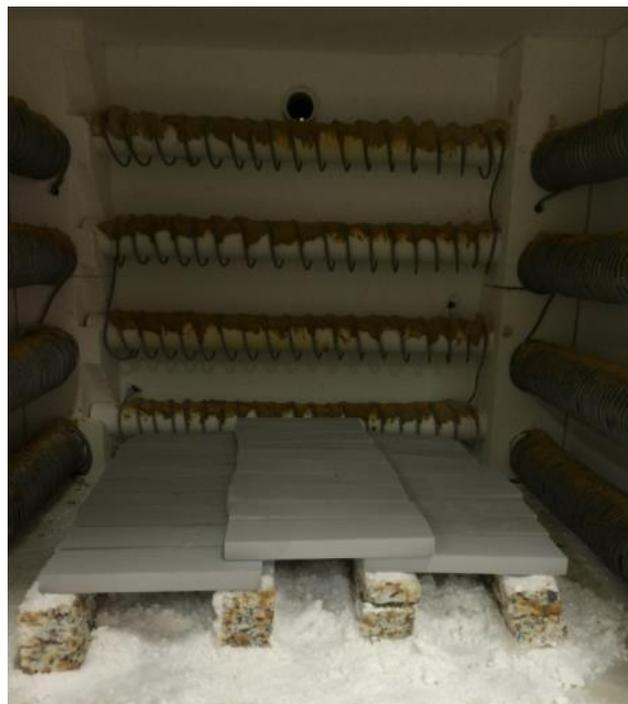
**Figura 10 – Disposição dos corpos de prova no interior do forno, pré queima.**
