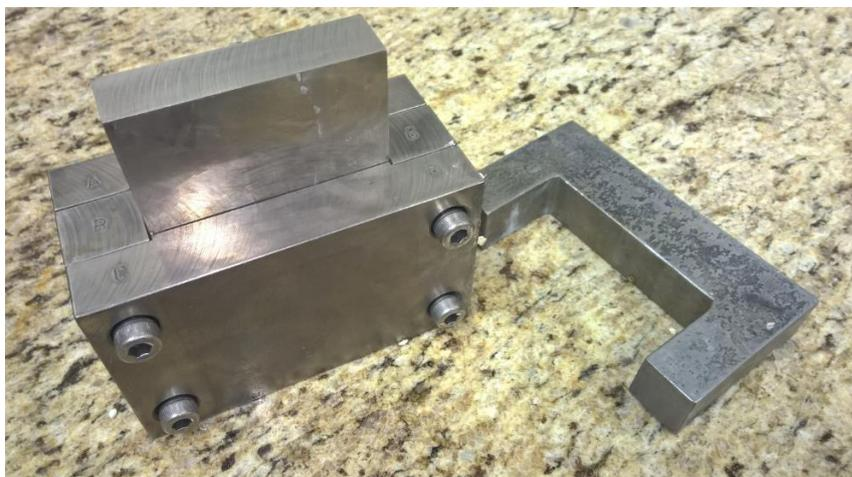
**Figura 4 – Molde metálico com formato retangular**
