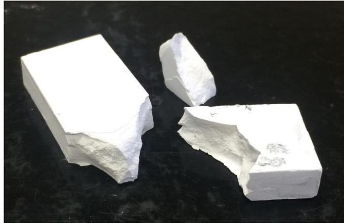
Figura 20 - Corpo de prova fraturado correspondente a composição de 40% Al
