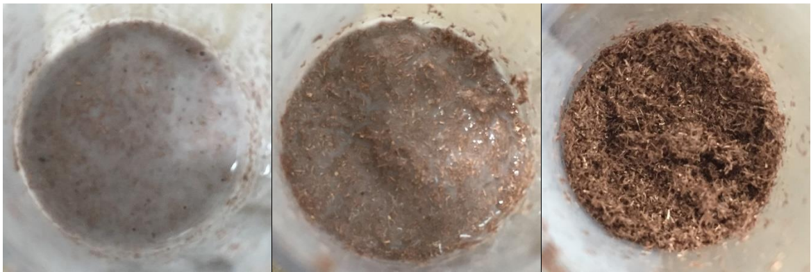
Figura 13. Amostras de cobre (em ordem): 50%, 70% e 90% de cobre em massa.
