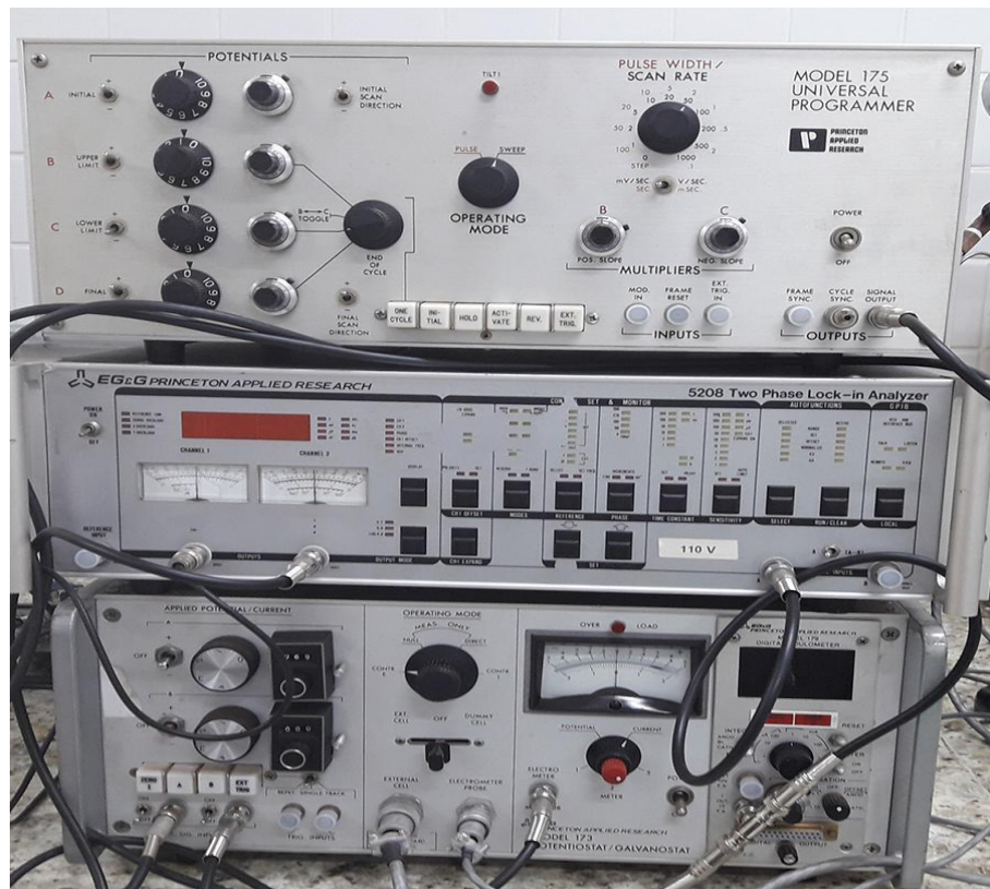
Figura 12: Equipamentos utilizados para determinação da voltametria cíclica e curva de polarização, em cima a rampa de potencial e embaixo o potenciostato.
