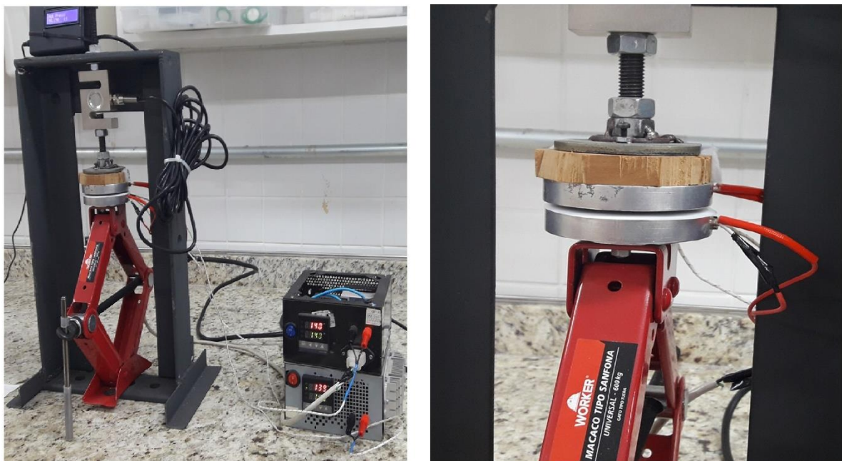
Figura 8: Equipamento prensa quente ( hot press ), com dois termostatos.
