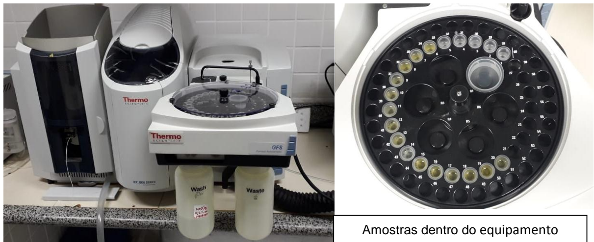
Figura 18 – Foto do Espectrômetro de Absorção Atômica com Forno de Grafite
