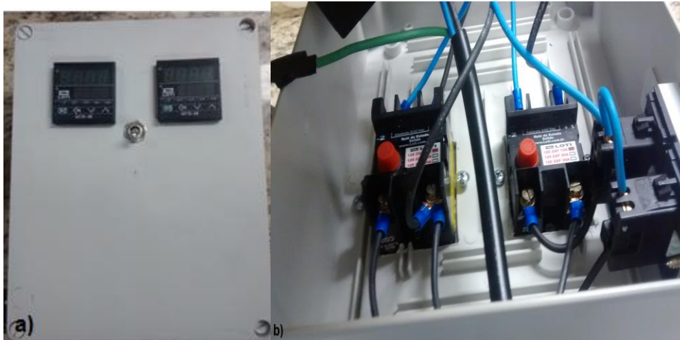
Figura 10 - a) Caixa de controle com switch on-off e controladores de temperatura. b) interior da caixa de controle com os relês de estado sólido e as tomadas
