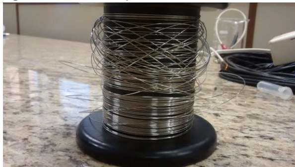
Figura 9 – Fio de níquel-cromo utilizado como resistência.
