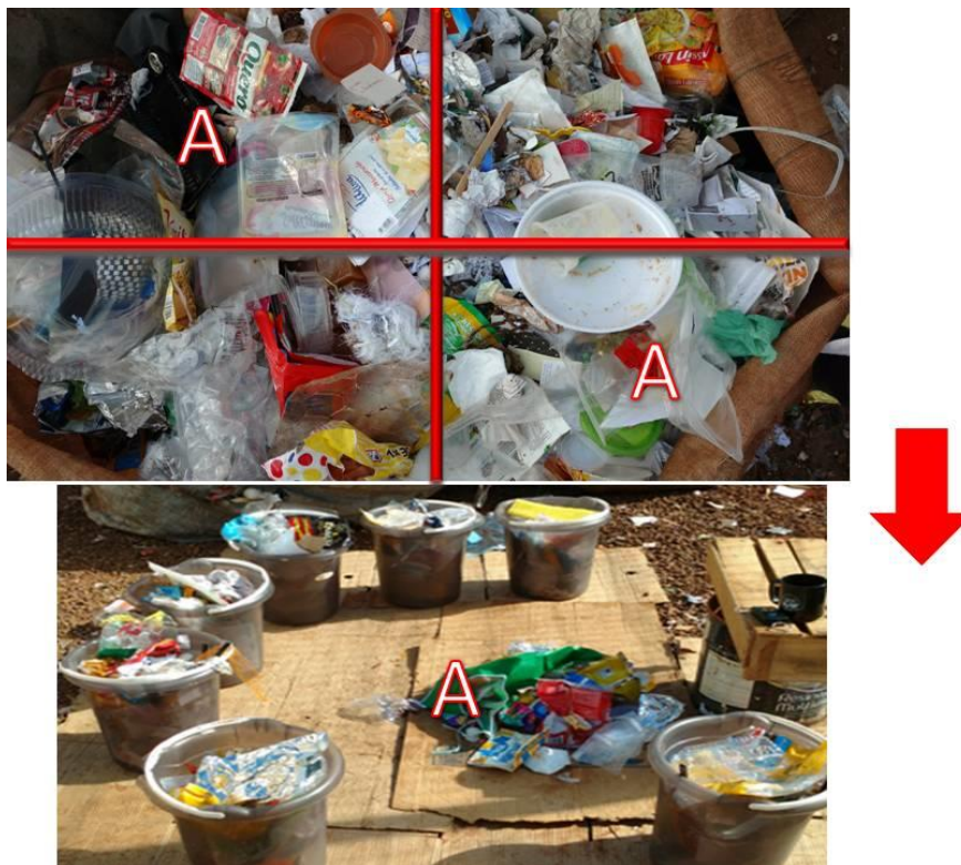
Figura 3 - Etapas do quarteamento para a obtenção da amostra de rejeitos.
