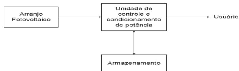
Figura 14 Sistema FV básico.
