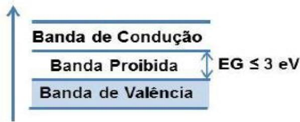
Figura 12 Diagrama da banda de um semicondutor.
