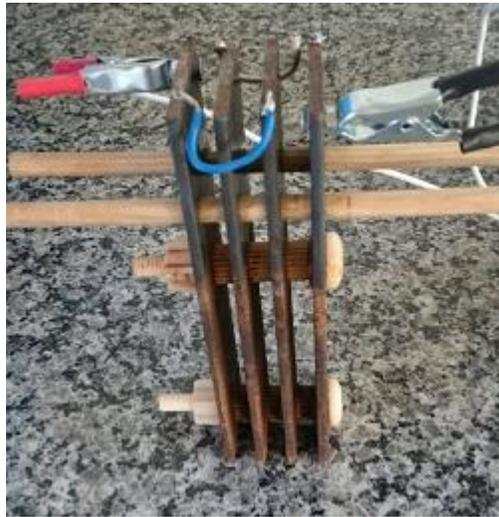
Figura 5: eletrodos de ferro conectados em paralelo
