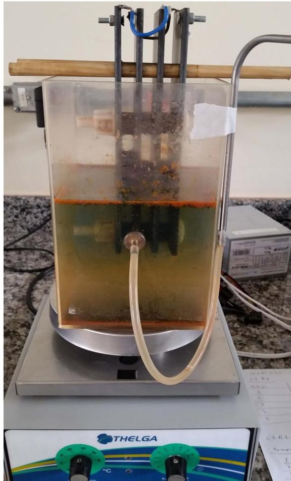
**Figura 4: Reator de eletrocoagulação, nível de bancada**
