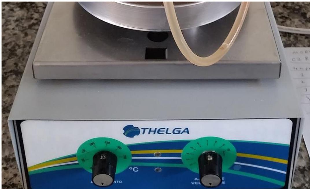
**Figura 7: Agitador magnético**
