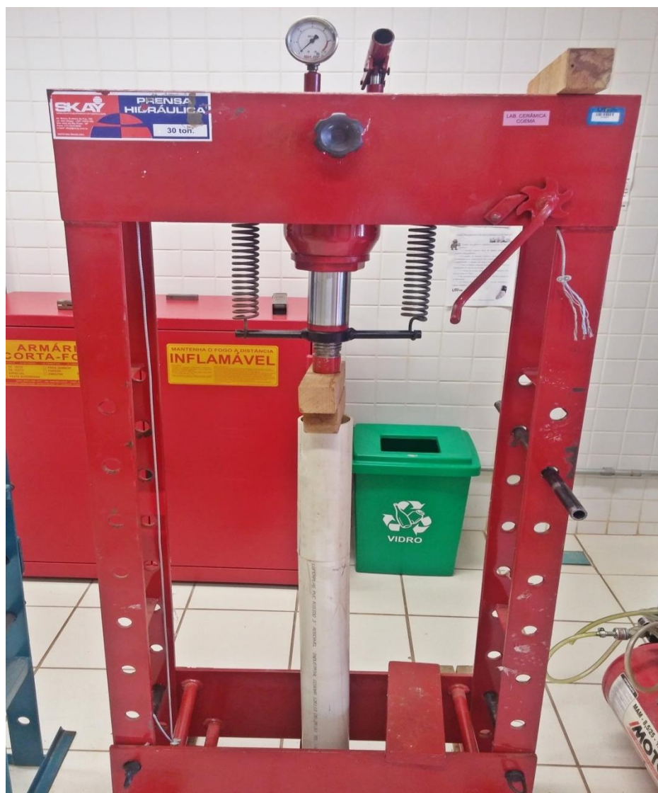
Figura 8 - Prensa hidráulica da marca Skay com capacidade de 30 toneladas, 2016.
