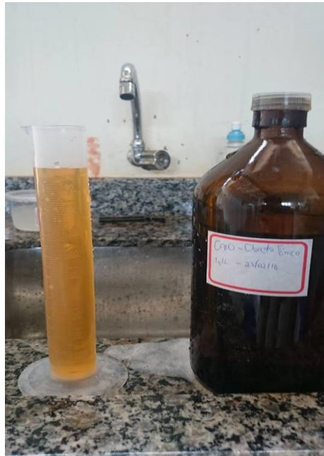
Figura 5: Solução coagulante de cloreto férrico. Fonte: Autoria própria (2016)
