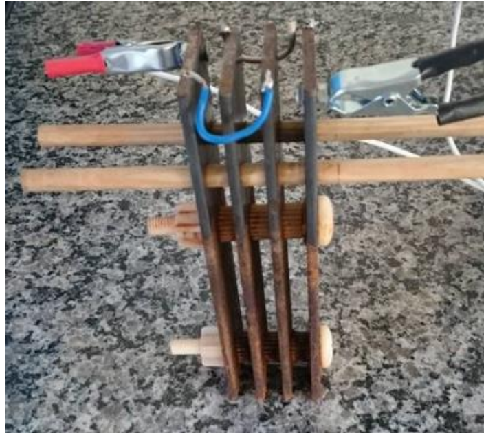
Figura 4: Esquema do sistema de eletrodos monopolares do reator. Fonte: Autoria própria (2016).
