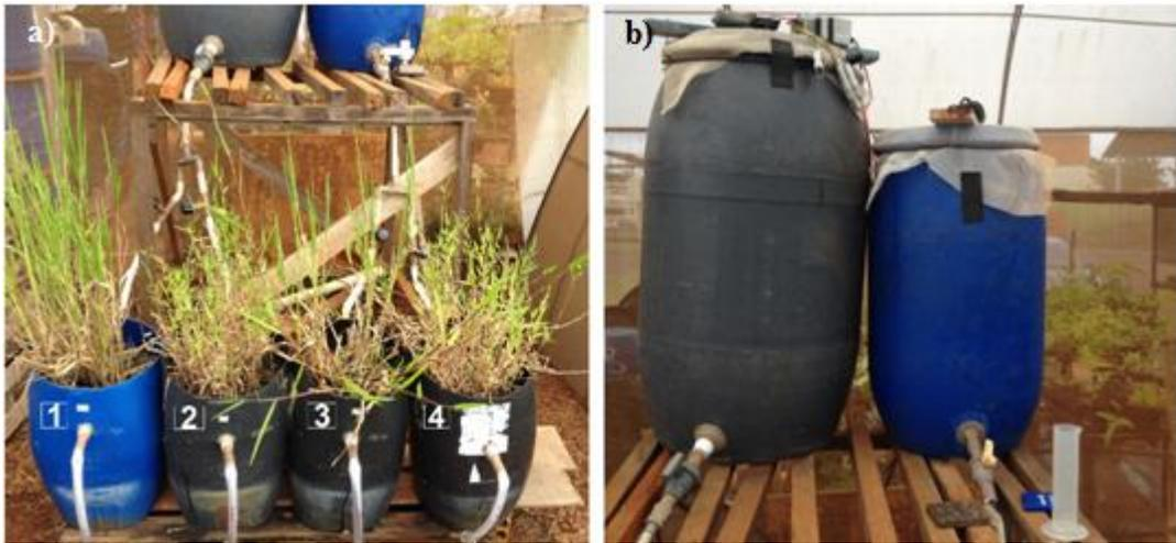
Figura 3 – Sistema de tratamento *wetlands*, a) Leitos; b) Tanques.
