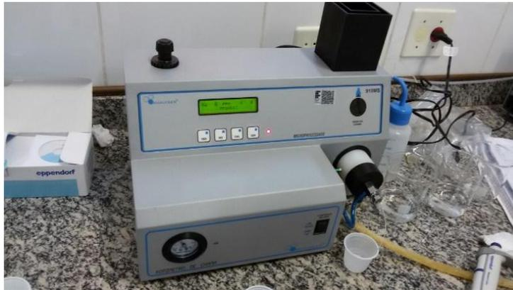
**Figura 9 – Fotômetro de chama do IFPR.
