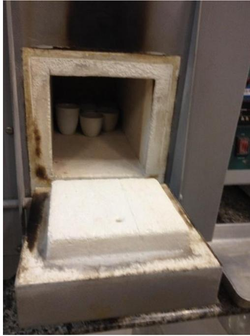
**Figura 13 – Disposição dos cadinhos no forno-mufla.**
