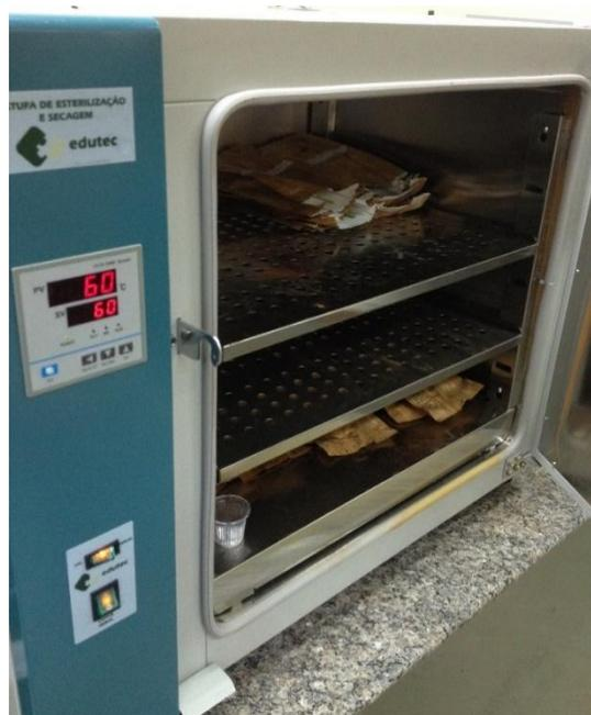
**Figura 10 - Secagem das amostras em estufa à 60<sup>o</sup>C.**
