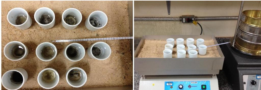
**Figura 14 – Amostras em manta aquecedora à 60°C.**
