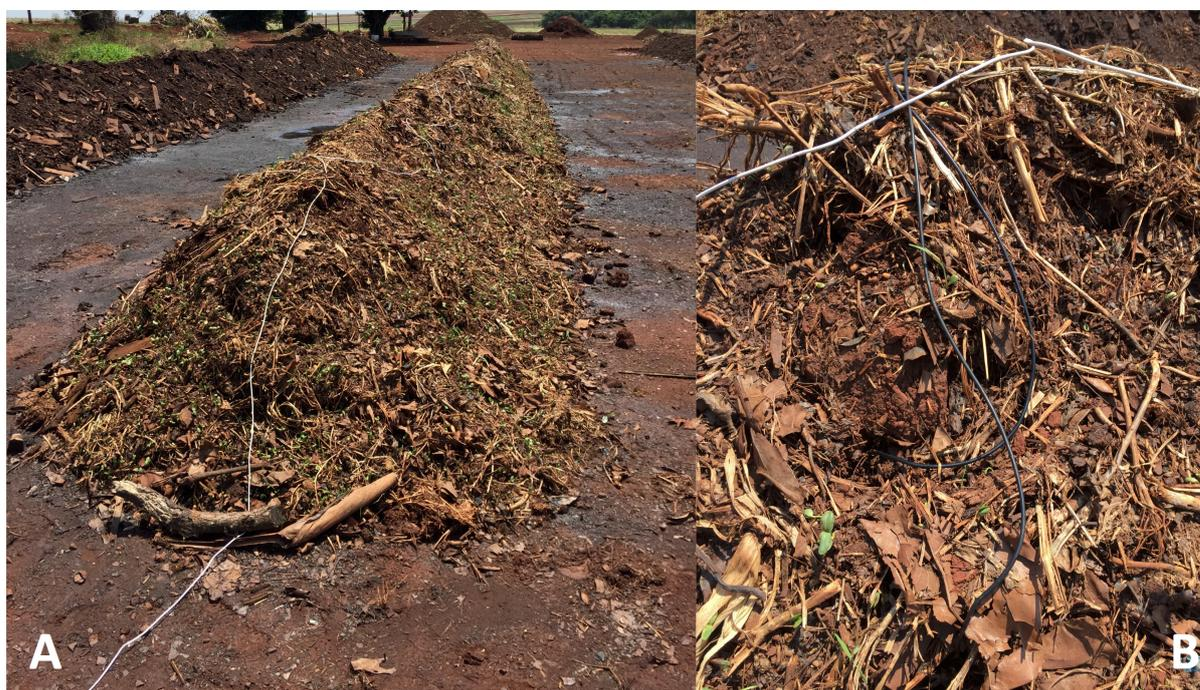
Figura 12 – Cabo sobre leira de compostagem onde foram soldados os sensores. (A) Visão geral da leira. (B) Detalhe do sensor inserido sobre a leira.
