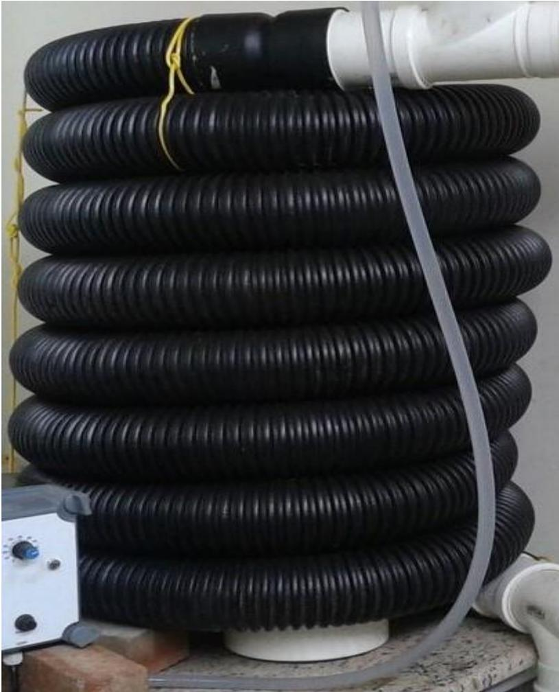
**Figura 5: Conduto corrugado montado.**
