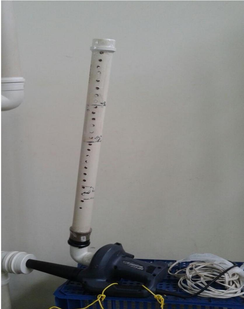
**Figura 6: Soprador de ar e cano controlador de vazão.**
