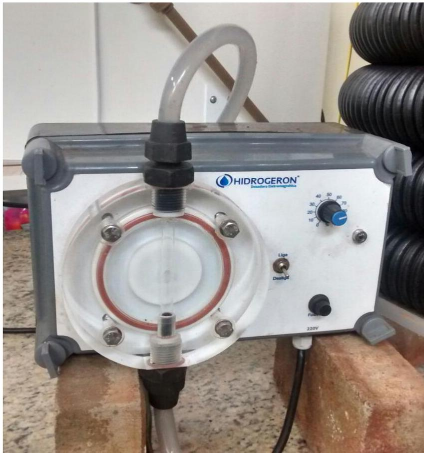
**Figura 7: Dosadora eletromagnética utilizada para bombear o efluente sintético.**
