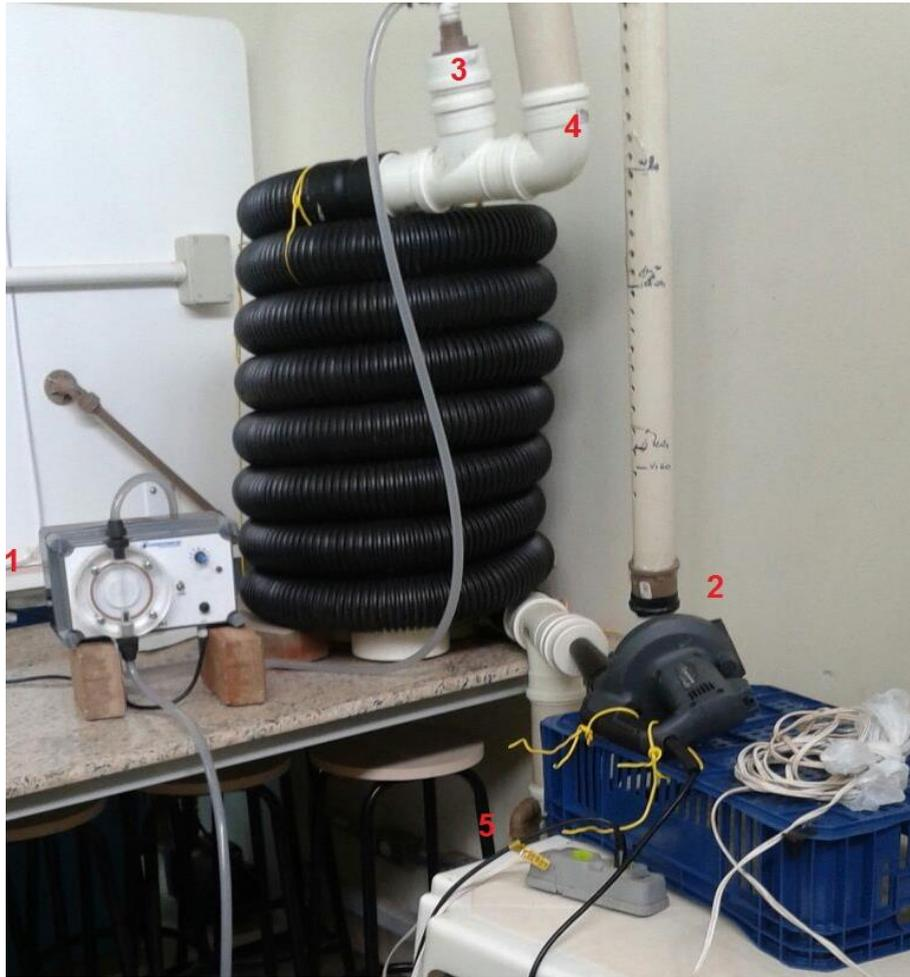
**Figura 4: Sistema de Air Stripping com conduto corrugado montado, onde: (1) dosadora eletromagnética; (2) soprador de ar; (3) entrada do conduto corrugado; (4) saída para o gás de arraste e (5) saída para o efluente tratado.**
