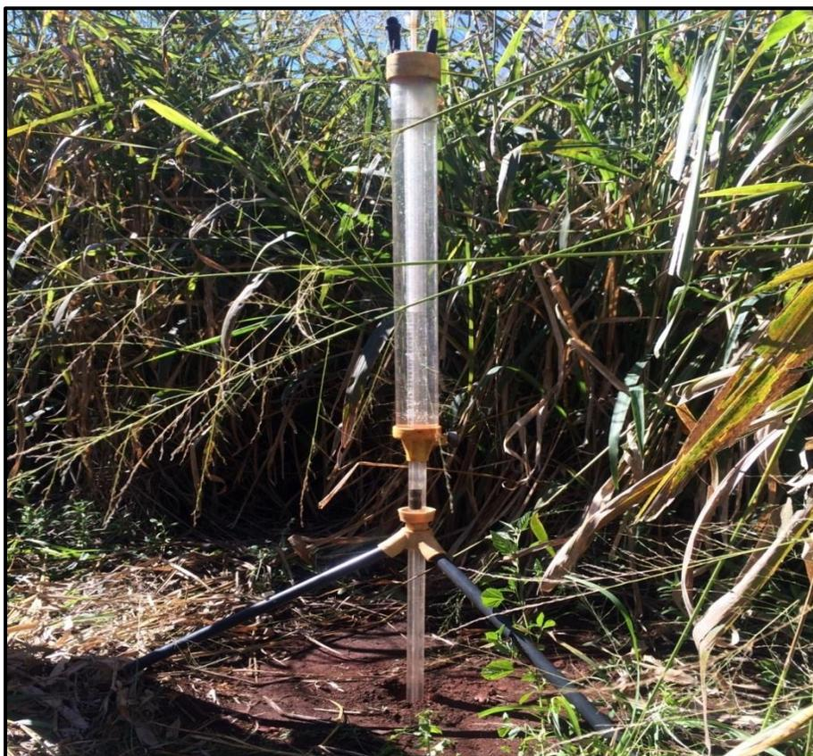
Figura 9: Ensaio de condutividade hidráulica utilizando o permeâmetro *Guelph*.
