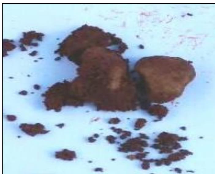
**Figura16: Fragmento de basalto intemperizado.**
