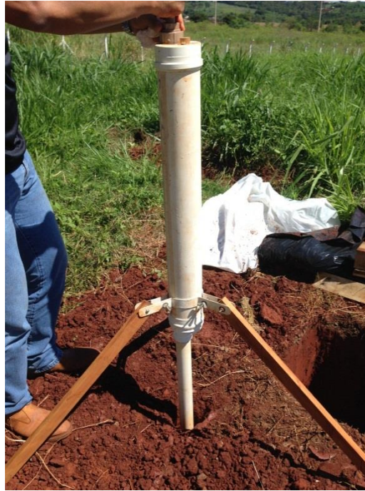
Figura 9 – Operação do Permeômetro de Guelph. Fonte: Autoria própria
