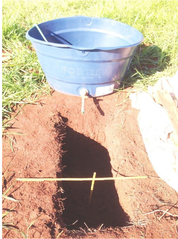
Figura 13 – Caixa D'água à montante da trincheira. Fonte: Autoria Própria.
