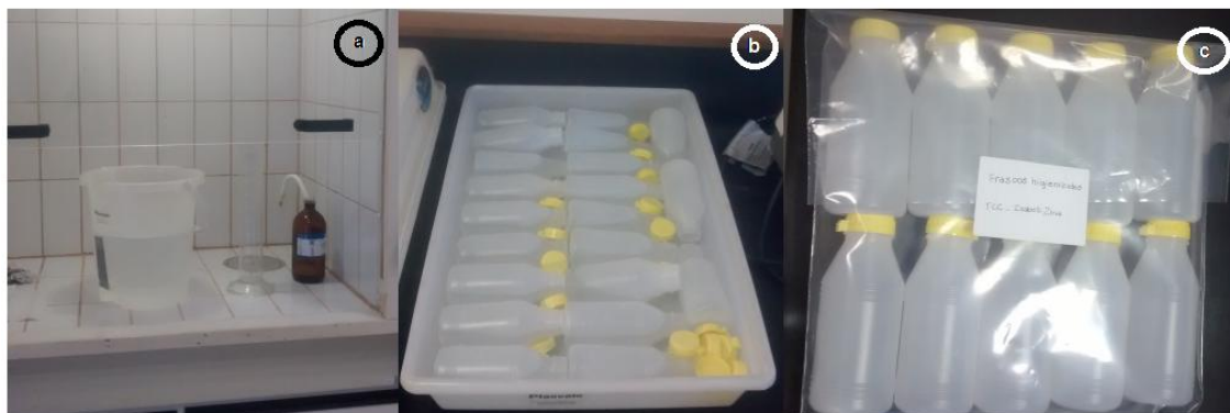
Figura 13 – Preparo dos frascos de coleta a) Preparo do ácido clorídrico a 10% b) Imersão dos frascos em ácido clorídrico a 10% c) Identificação dos frascos já higienizados. Fonte: Autoria própria.
