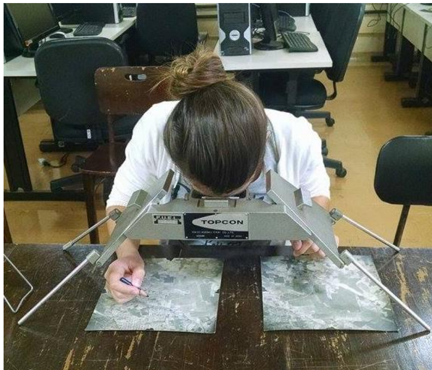
Figura 8 – Técnica de fotointerpretação utilizando estereoscópio da marca Topcon fornecido pela Universidade Estadual de Londrina - UEL. Fonte: Autoria própria.
