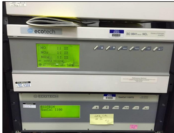
Figura 15 - Equipamento modelo EC 9841 que mede NO x . Fonte: A autoria própria (2015).
