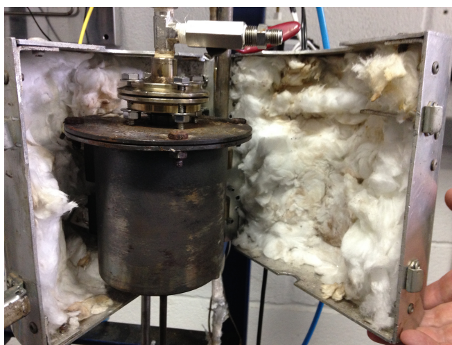
Figura 7: Forno elétrico para aquecimento do reator.
