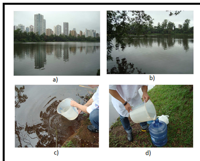
Figura 4: Coleta do dia 06/02/2015. a) e b) aspecto geral do Lago Igapó II; c) coleta de água do lago com o balde plástico; d) armazenamento em galão plástico.
