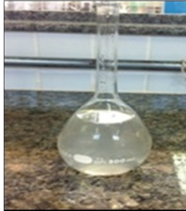
Figura 8: Solução coagulante de sulfato de alumínio.
