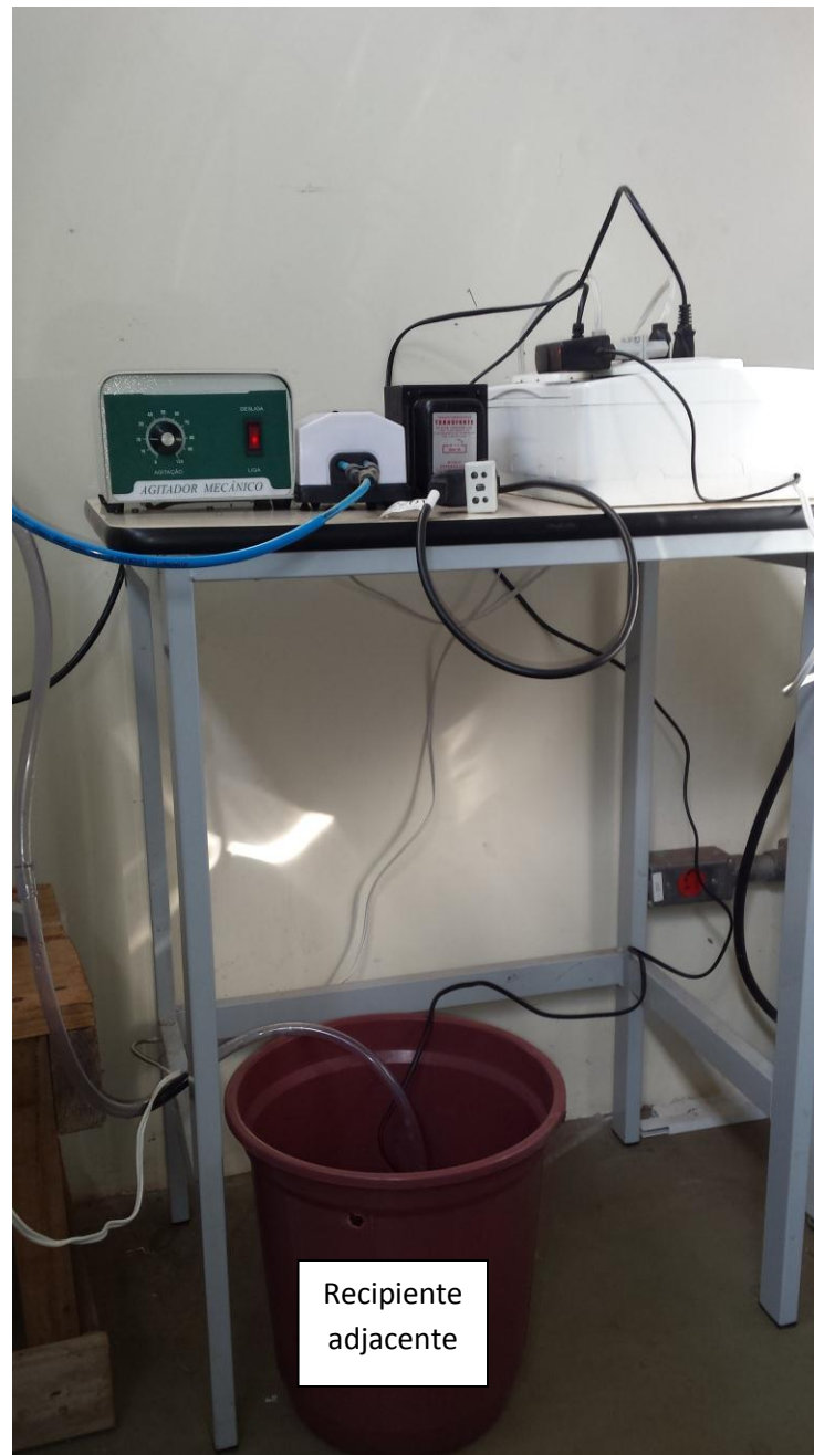
Figura 9: Recipiente adjacente de alimentação do reator.
