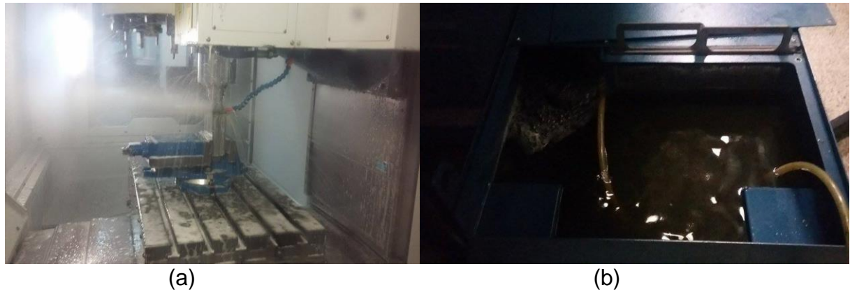
Figura 2 – Máquina de fresamento. (a) Visão lateral do local de usinagem das peças. (b) Detalhe do reservatório onde se realizavam as coletas de amostra.
