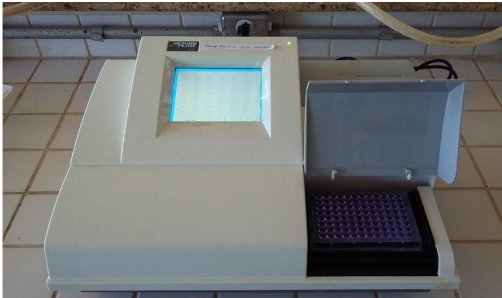
Figura 11 – Leitura da placa de poços U em aparelho ELISA. Fonte: Aatoria Própria
