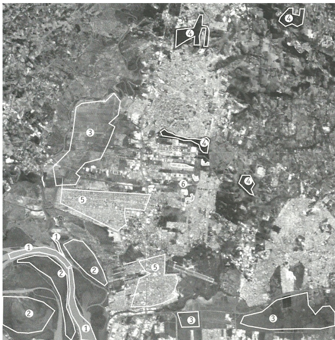
Figura 6 - Áreas de treinamento selecionadas para classificação supervisionada, sendo que os números representam classes definidas pelo autor (como o número 3 que se refere à classe de solo exposto).
