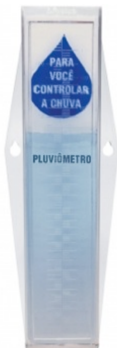
Figura 6 – Pluviômetro utilizado nas medições da precipitação. Fonte: J.ProLab Ltda.
