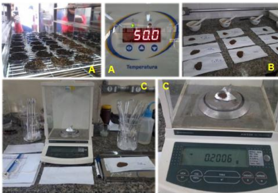
Figura 14: Etapas da análise de Nitrogênio Total. Fonte: Gonçalves (2014).
