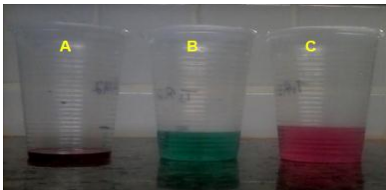
Figura 16: Diferentes colorações durante as etapas da análise de NTK: A – ácido bórico; B – amostra destilada; C – amostra titulada. Fonte: Gonçalves (2014).
