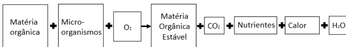
Figura 1: Fluxograma do processo simplificado da compostagem Fonte: Fernandes e Silva (1996).
