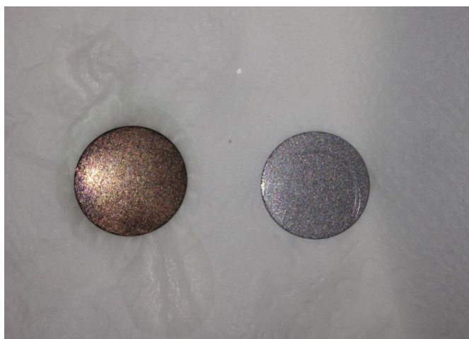
Figura 16: Placa a esquerda com níquel, e a direita sem níquel.
