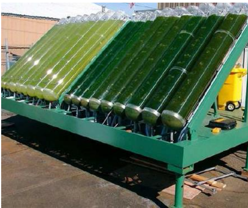
Figura 6 – Fotobiorreator tubular verticalmente inclinado para o cultivo fechado de microalgas.
