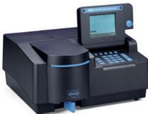
Figura 28 – Espectrofotômetro HACH DR/4000. Fonte: HACH (2014).
