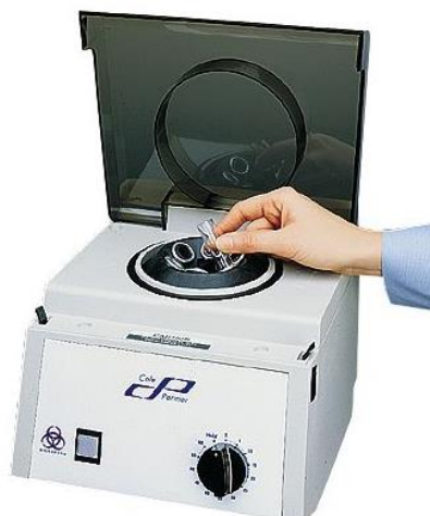
Figura 27 – Centrifuga Cole-Parmer EW-17250-10 utilizada para concentração das amostras. Fonte: Cole-Parmer (2014).
