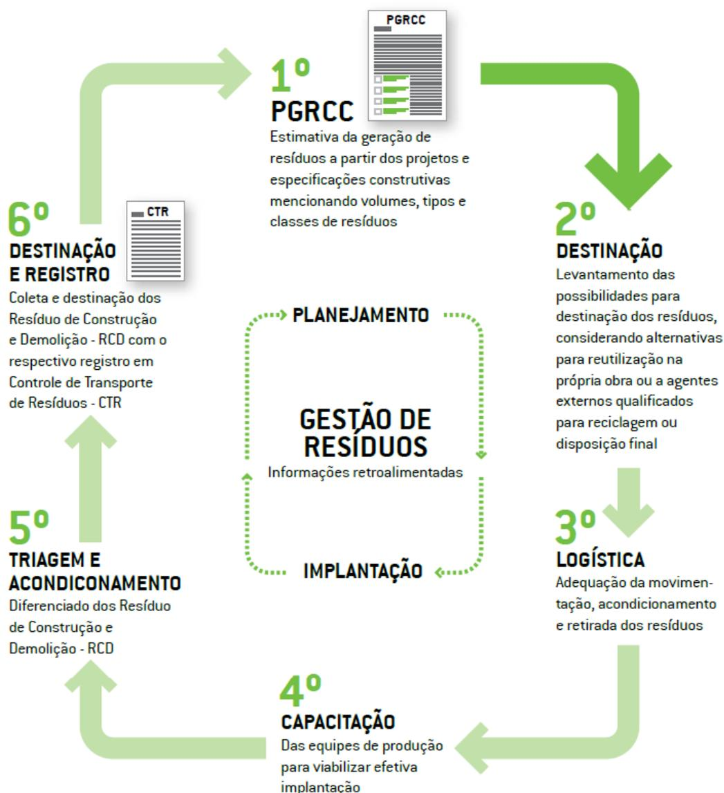
**Figura 6: Etapas para a implantação do Plano de Gerenciamento de Resíduos da Construção Civil.**
