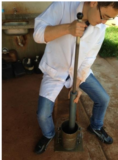
Figura 17: Soquete aplicando energia de compactação.
