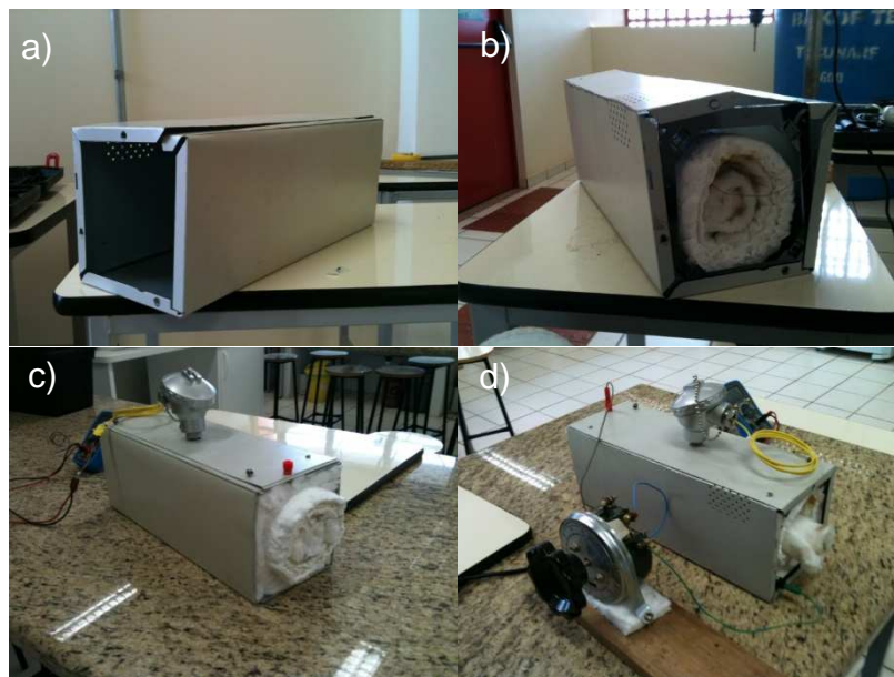
Figura 11 – Construção do forno: a) produção da cápsula, b) instalação do equipamento de aquecimento do reator, c) preenchimento dos espaços vazios com massa refratária e d) equipamento em sua fase final.
