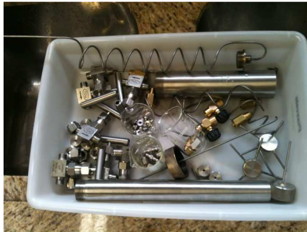
Figura 6 - Parte das peças utilizadas para montagem da unidade de reforma a vapor. Fonte: Próprio autor
