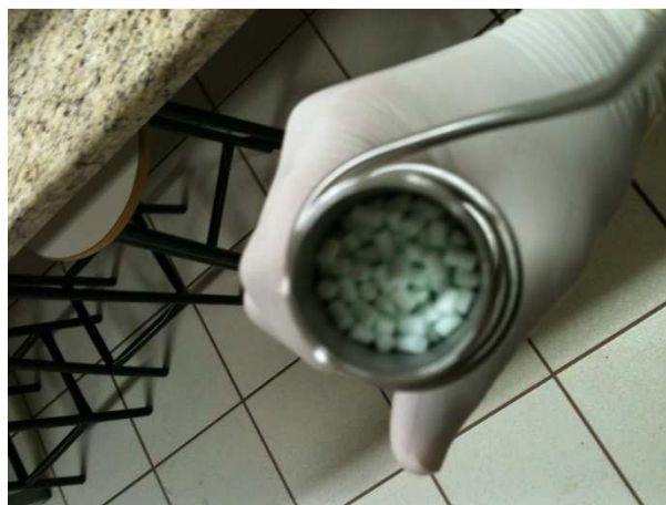
Figura 15 - Inserção dos catalisadores depositados com cloreto de níquel no reator para etapa de redução à base de hidrogênio Fonte: Próprio autor
