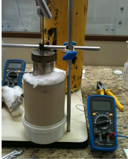
Figura 9 - Umidificador Fonte: Próprio autor
