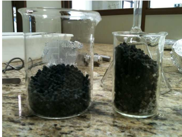
Figura 16 - Catalisador de alumina e níquel reduzido Fonte: Próprio autor
