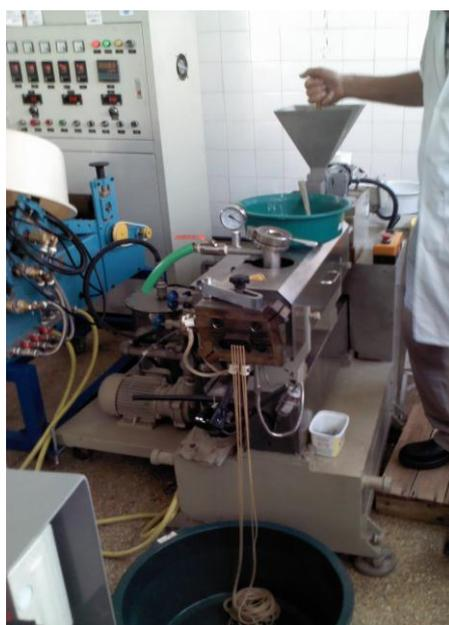
**Figura 23 - Extrusão dos compósitos.**
