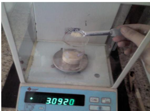
**Figura 19 - Pesagem em balança analítica do bagaço de cana-de-açúcar.**
