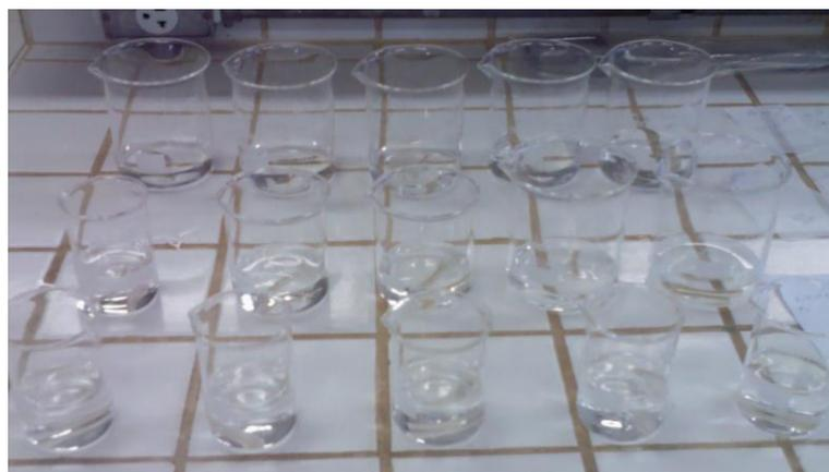
**Figura 25 – Imersão das amostras em água destilada.**
