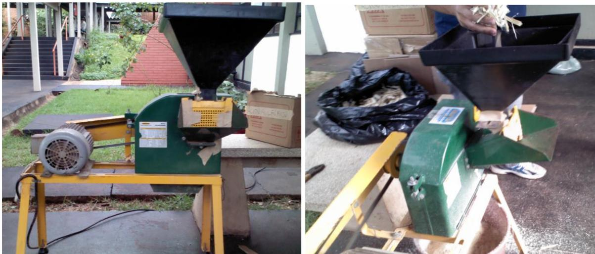
**Figura 15 - Moinho de facas do tipo “Thomas Wiley” – à esquerda e o processo de trituração do Bagaço de cana-de-açúcar à direita.**
