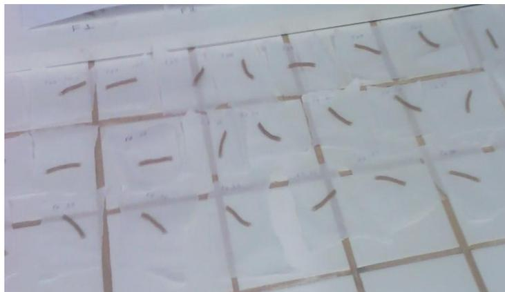
**Figura 24 – Preparação das amostras para determinação Da CAA dos compósitos produzidos.**
