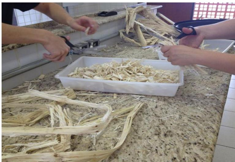
**Figura 13 – Corte manual do bagaço de cana-de-açúcar seco.**
