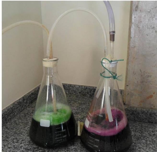
Figura 12 – Sistema de recuperação de  $\text{N-NH}_3$  em funcionamento
