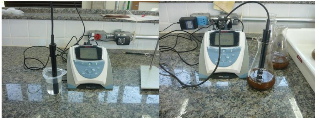
**Figura 28 - Condutímetro e demonstrativo da aferição da condutividade elétrica.**
