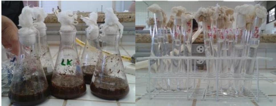
**Figura 45 - Procedimento de diluição em série das amostras coletadas nas leiras e reatores. a) preparação da primeira diluição ( $10^{-1}$ ); b) tubos de ensaio contendo a série de diluições obtidas.**
