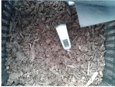
**Figura 22 - Demonstração real dos pontos pré-estabelecidos para determinação de temperatura nos reatores de vermicompostagem.**
