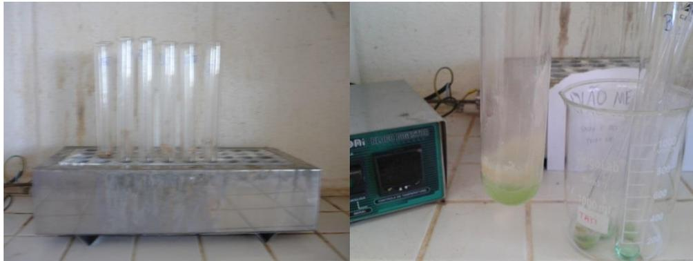
**Figura 39 - Tubos dispostos no bloco e seu aspecto após a digestão sulfúrica.**
