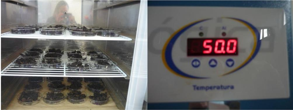
Figura 35 - Disposição das amostras na estufa e sua temperatura ao longo das 48 horas.
