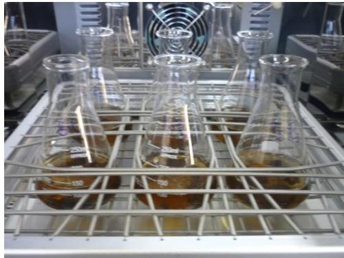
**Figura 26 - Amostras no shaker para determinação de pH.**
