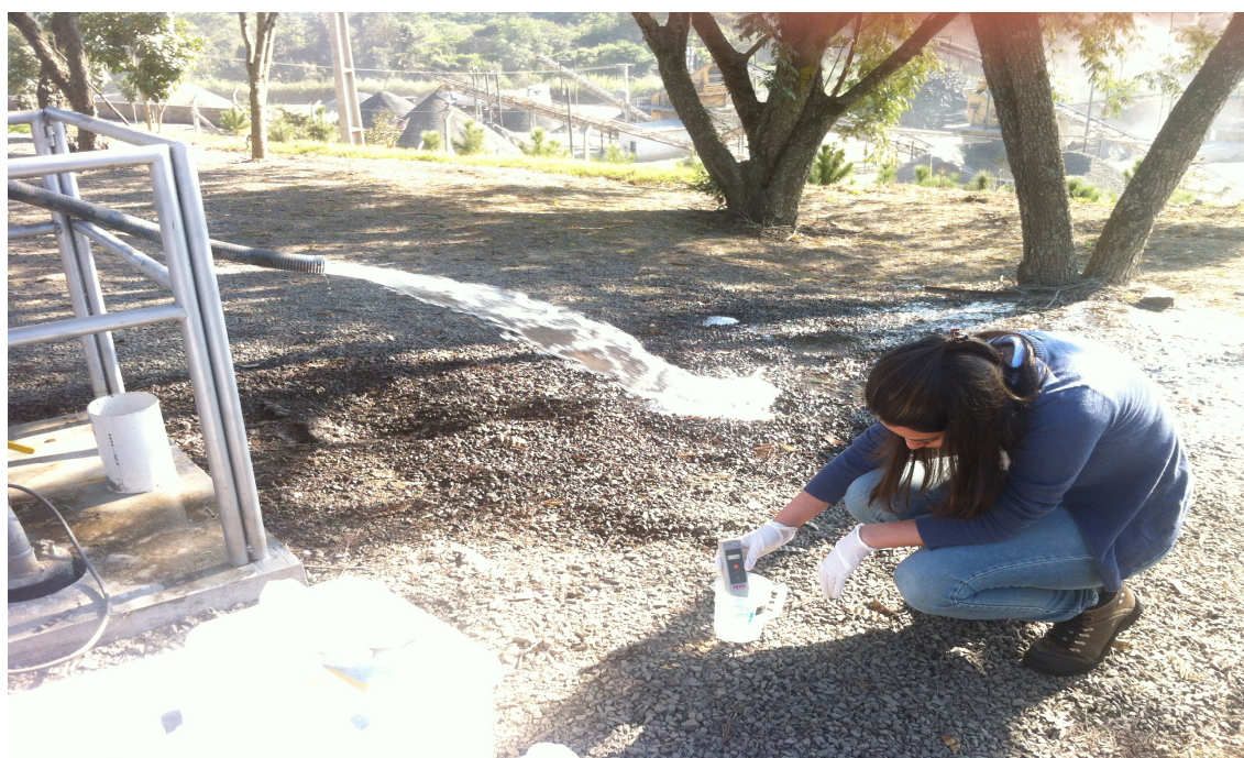
Figura 7.7. Medição de pH na amostra coletada do Poço Tubular Profundo.
