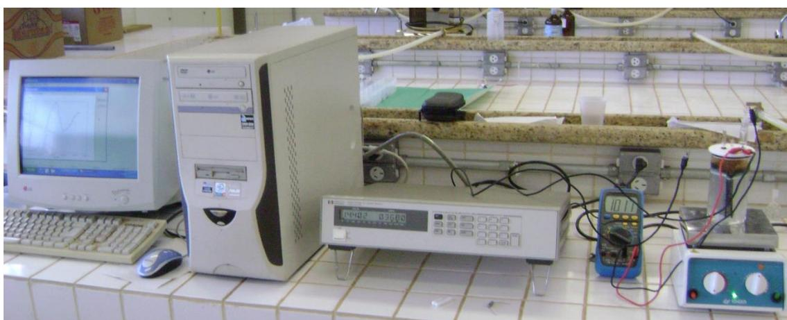
**Figura 2** Unidade de tratamento eletroquímico com as conexões do sistema de controle e aquisição de dados.
