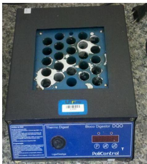
Figura 22 – Bloco Digestor utilizado na determinação de DQO.
