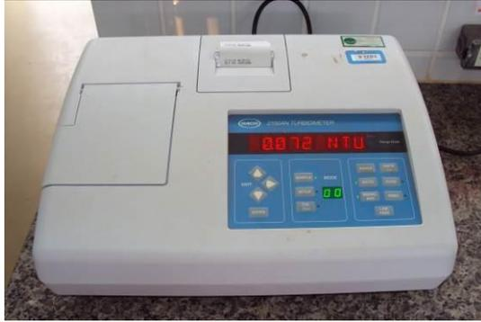
Figura 15 – Turbidímetro disponível no laboratório.
