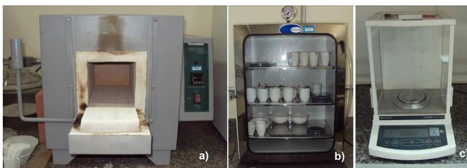
Figura 14 – Principais equipamentos utilizados na análise de sólidos. a) Mufla; b) Dessecador; c) Balança analítica.
