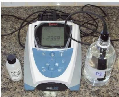
Figura 13 – Demonstração da aferição da Condutividade Elétrica.
