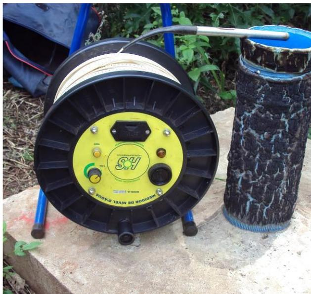
**Figura 9 – Medidor de nível d'água.
