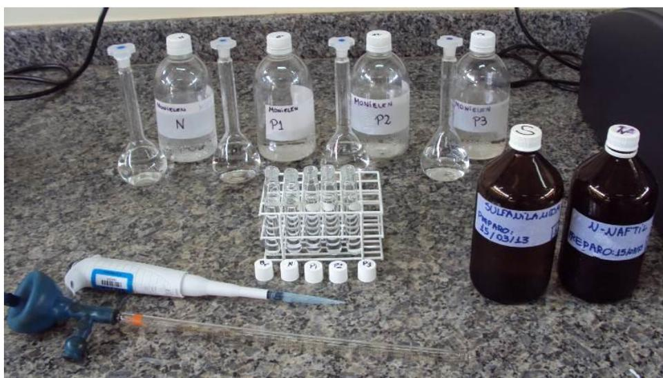
Figura 18 – Principais materiais utilizados na determinação do Nitrito.
