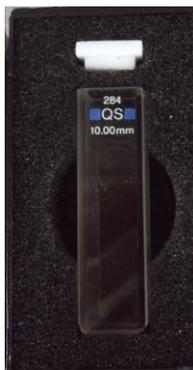
**Figura 20 – Cubeta de quartzo utilizada na determinação do Nitrato.**
