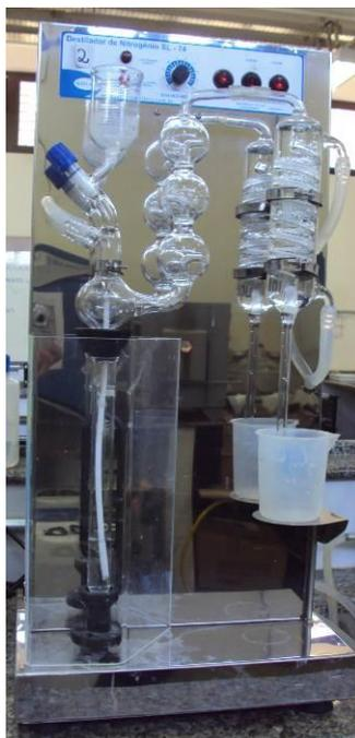
Figura 17 – Aparelho destilador de Nitrogênio.
