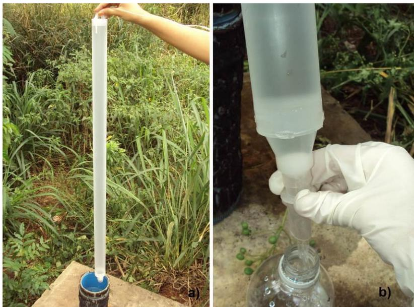
**Figura 11 – a) Foto com bailer utilizado para purgeamento dos poços; b) Em destaque coleta da amostra d'água em recipientes plásticos para armazenamento temporário e transporte das amostras.**
