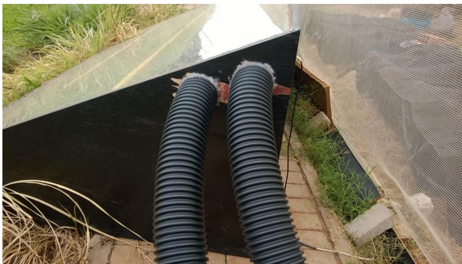
Figura 16. Dutos de 4 polegadas para coletar o ar quente da caixa de aquecimento. Fonte: Autoria própria.
