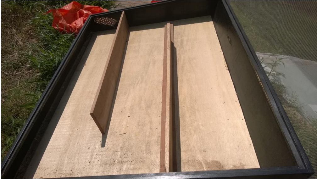
Figura 13. Fixação de madeiras para direcionamento do fluxo de ar no interior da caixa de aquecimento.
