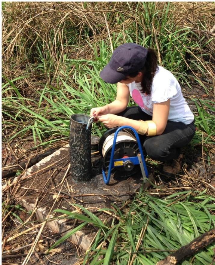
**Figura 8 - Medição do nível de água subterrânea no poço P3.
