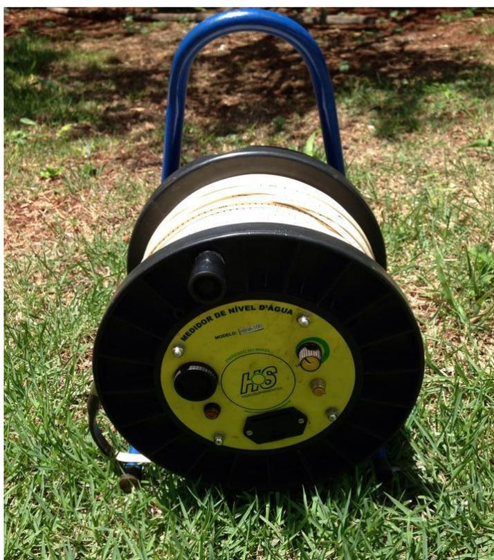
**Figura 7 - Medidor de nível d'água**
