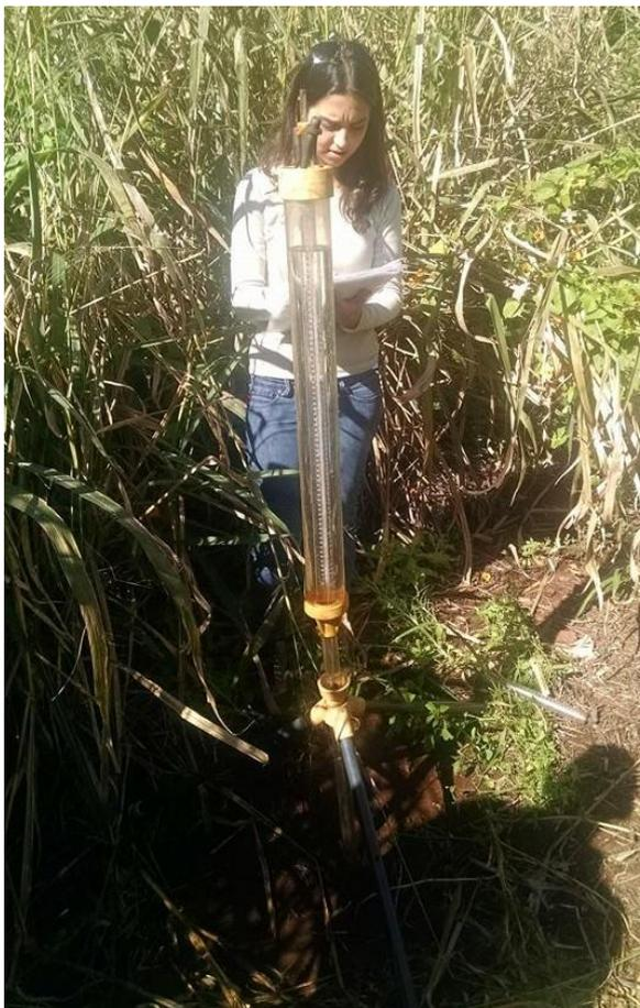
**Figura 9- Realização do ensaio de infiltração *in situ* utilizando o Permeâmetro *Guelph*.
