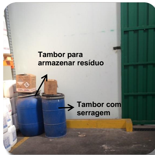
Figura 7 - Tambor plástico para armazenar resíduo em caso de vazamento e tambor plástico com serragem.
