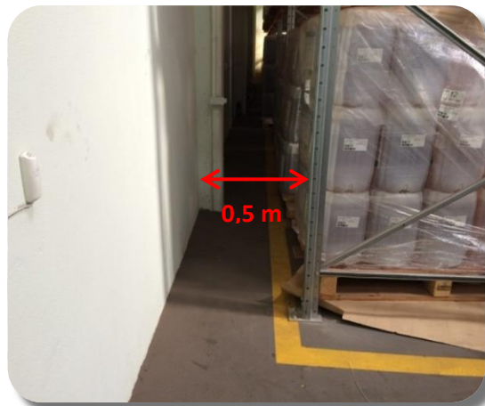
Figura 5 - Distância mínima de 0,5 metros da parede. Fonte: Próprio Autor.
