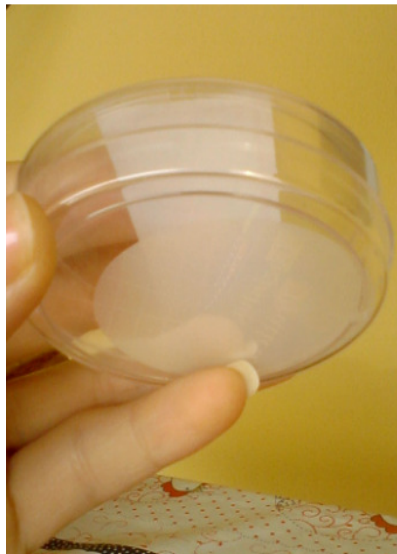
Figura 16 - Filtro coletor de material particulado inalável grosso Fonte: Autor (2014).
