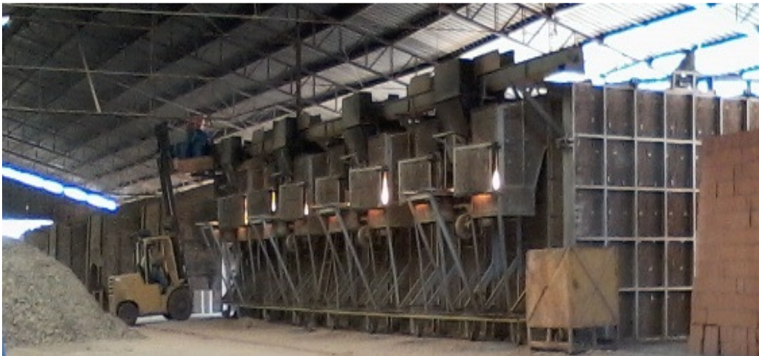
Figura 33 – Processo de queima dos tijolos por forno móvel Fonte: Autor (2014).
