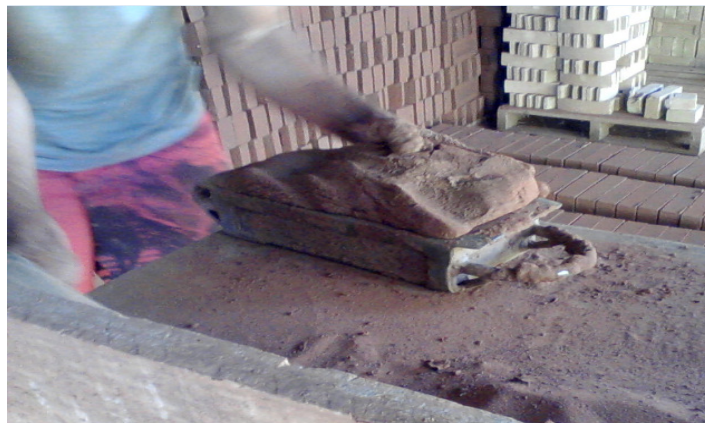
Figura 43 - Obtenção do formato desejado através de formas prontas Fonte: Autor (2014).
