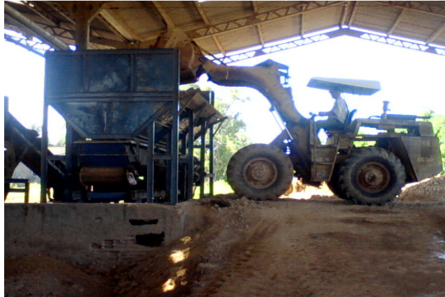
Figura 20 – Abastecimento de matéria-prima no caixão alimentador Fonte: Autor (2014).
