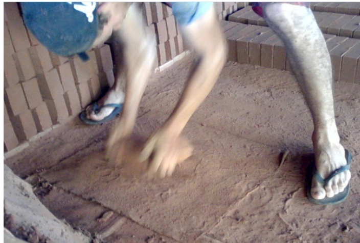
Figura 42 - Modelagem de peças por trabalho braçal Fonte: Autor (2014).
