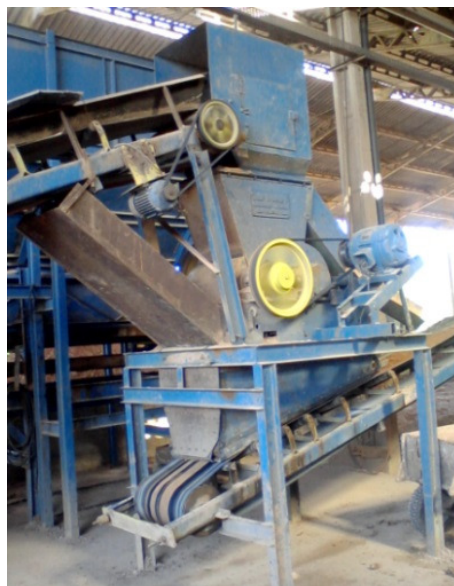
Figura 21 – Desintegrador Fonte: Autor (2014).
