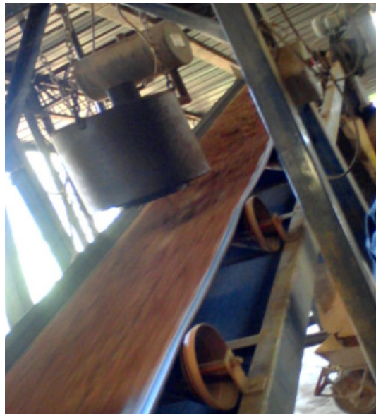
Figura 26 – Removedor de metais Fonte: Autor (2014).
