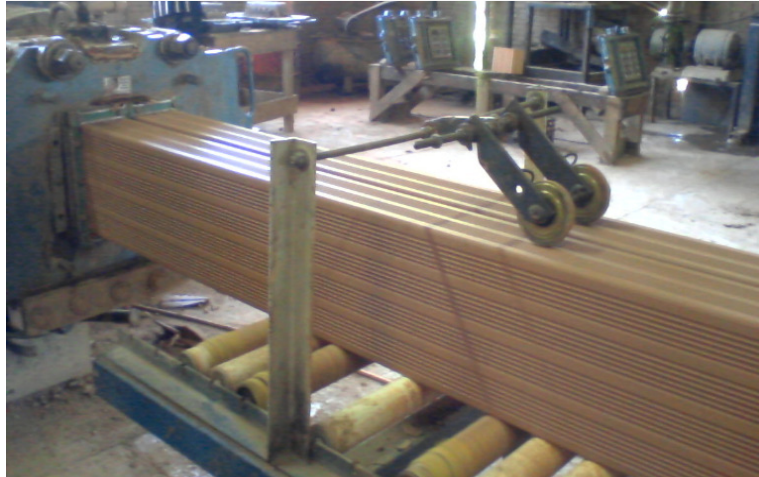
Figura 27 – Formação do bloco pela extrusora Fonte: Autor (2014).
