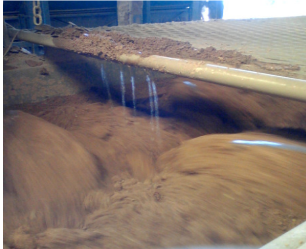
Figura 25 – Misturador com adição de água Fonte: Autor (2014).
