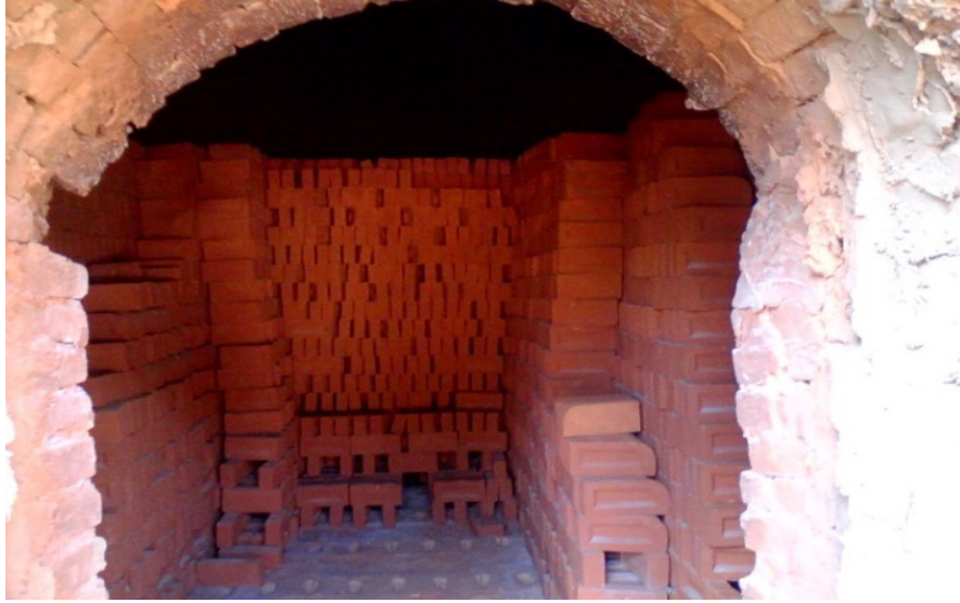
Figura 47 - Montagem do forno para queima Fonte: Autor (2014).
