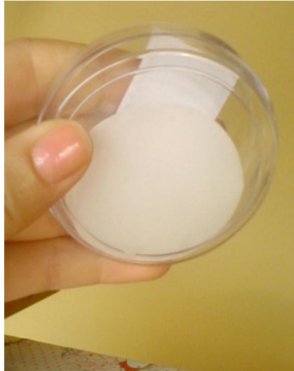
Figura 17 - Filtro coletor de material particulado inalável fino Fonte: Autor (2014).
