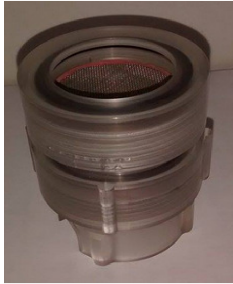
Figura 15 - Amostrador de particulado fino e grosso Fonte: Autor (2014).
