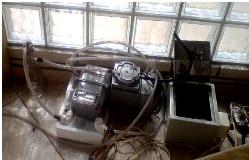
Figura 14 - Bomba a vácuo e totalizador de volume Fonte: Autor (2014).
