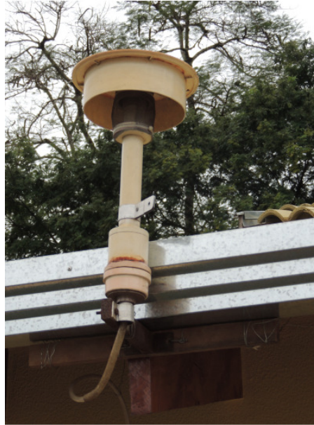
Figura 13 - Amostrador de particulado fino e grosso e tubulação de admissão Fonte: Autor (2014).
