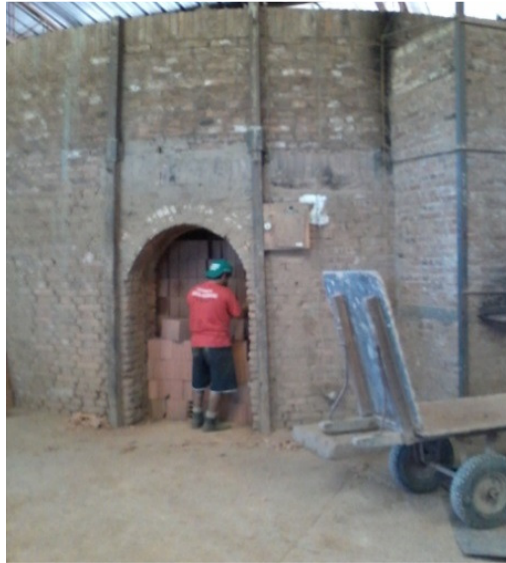
Figura 36 – Preenchimento do forno abóboda Fonte: Autor (2014).
