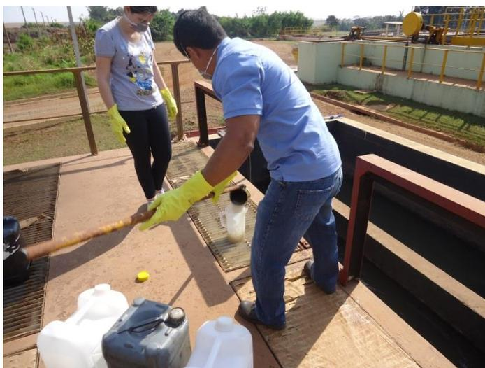
**Figura 04: Coleta do esgoto sanitário na ETE -Norte após o tanque desarenador.**
